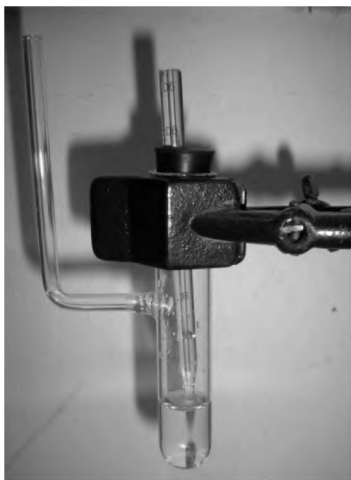
Рис. Л.6. Измерительная ячейка с капилляром для измерения поверхностного натяжения методом максимального давления пузырьков
