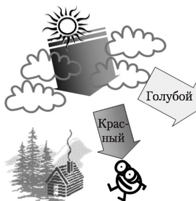
Рис. 3.7. Рассматривая источник света через высокодисперсную систему, наблюдатель видит красную часть спектра
