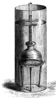
Рис. 8.1. Осмометр Грэма 1
