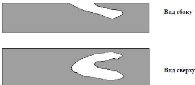
Рис. 8.3. Эрозионная коррозия ЛКМ
