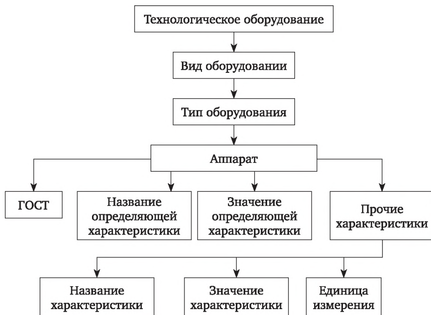
Рис. 4.1. Обобщенная схема базы данных «Технологическое оборудование»
