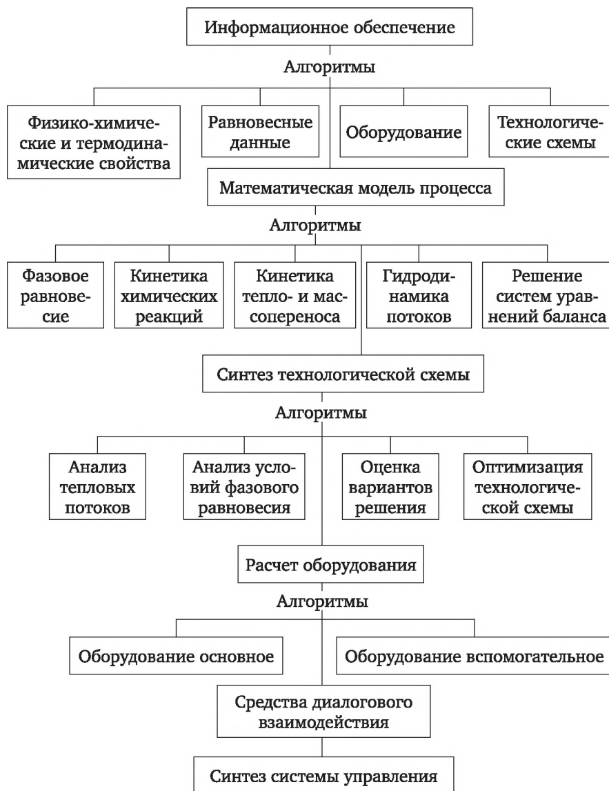
Рис. 4.3. Состав прикладного математического обеспечения САПР
