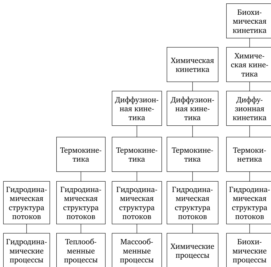
Рис. 1.1. Составляющие типовых процессов химической технологии
