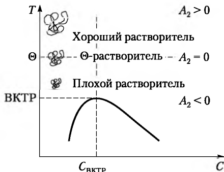
Рис. 2.10. Влияние температуры на термодинамическое качество растворителя по отношению к полимеру для системы с ВКТР
