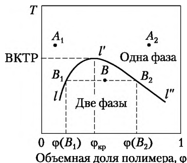
Рис. 2.3. Пример фазовой диаграммы с ВКТР для двухкомпонентной системы «полимер – растворитель»
