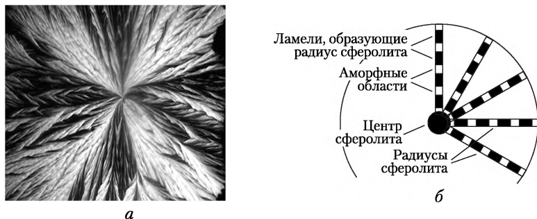
Рис. 4.27. Микрофотография сферолита полипропилена (а) и схематичное изображение структуры сферолита (б)
