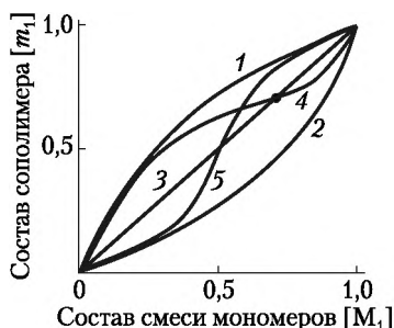
Рис. 5.1. Зависимость состава сополимера от состава смеси мономеров
