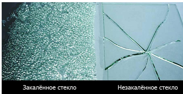
Рис. 5. Характер разрушения листовых стекол
