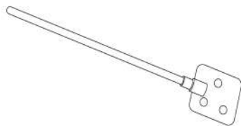
Рис. 68. Лопастная насадка в виде пластины с отверстиями
