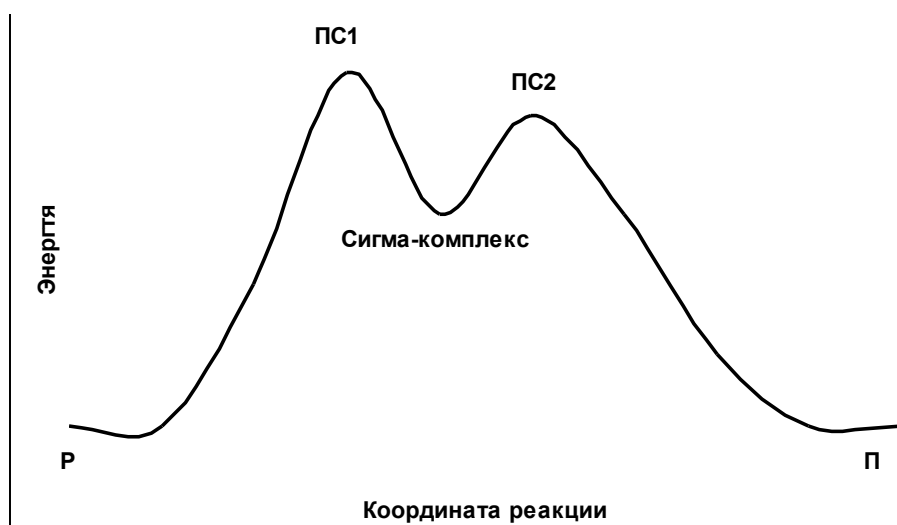
Рис. 1.1. Изменение энергии реагирующей системы (Р – реагенты, ПС1 – переходное состояние 1, ПС2 - переходное состояние 2, П – продукты реакции)
