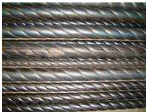
Рис. 1.30. Профилированные трубы
