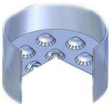
Рис. 2.6. Низкопрофильная колпачковая тарелка
