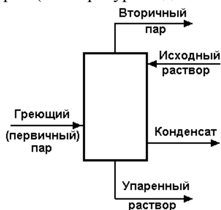
Рис. 4.1. Схема материальных потоков в выпарном аппарате
