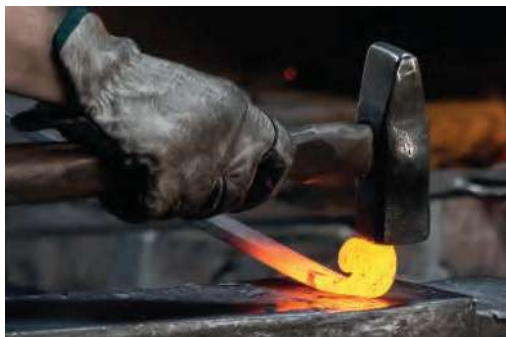
Рис. 104. Ковка металла как демонстрация его пластичности
