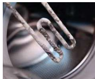
Рис. 112. Накипь на обогревательном элементе стиральной машины
