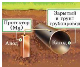
Рис. 116. Защита от коррозии подземного стального трубопровода
