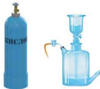
Рис. 73. Хранение кислорода в баллонах и газометре
