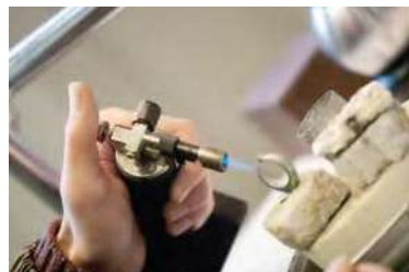
Рис. 66. Сварка ювелирных изделий кислородно-водородным пламенем
