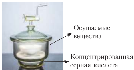
Рис. 86. Эксикатор для хранения и сушки гигроскопичных веществ
