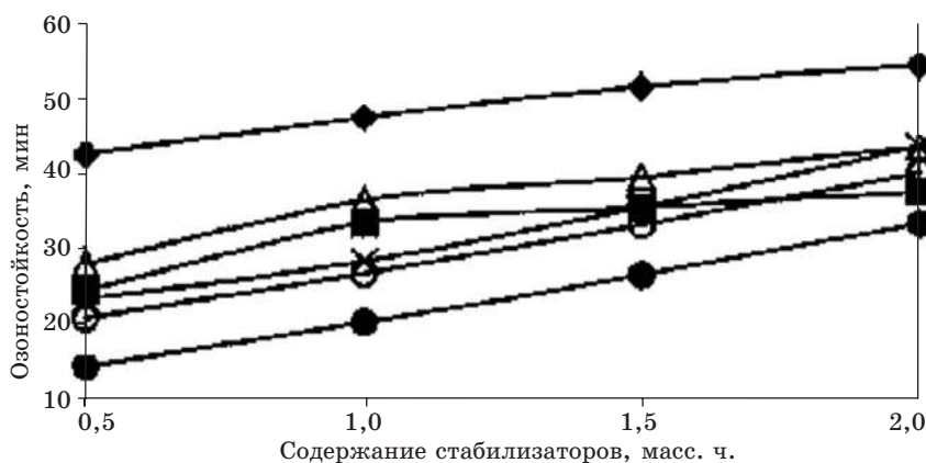
РИС. 12. Зависимость озоностойкости ненаполненных вулканизатов на основе СКИ-3 от содержания стабилизатора при концентрации озона 5 \cdot 10^{-4} об. %:
