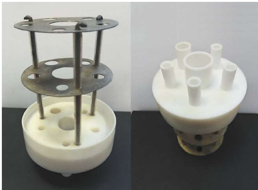
Рис. 6. Изготовленная фторопластовая пробка с теплоотражающими экранами
