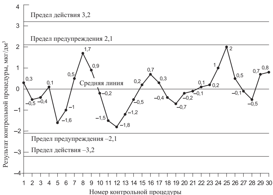
Рис. 1.18. Карта Шухарта для контроля погрешности результатов анализа с использованием ОК (в единицах определяемых содержаний) по результатам определения хлористых солей в нефти
