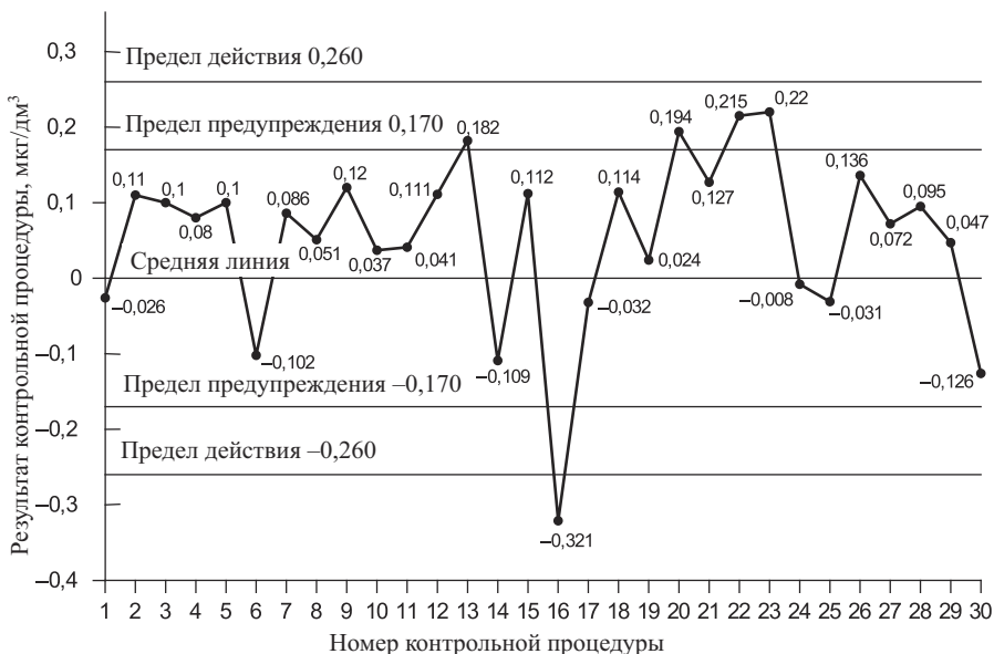
Рис. 1.14. Контрольная карта Шухарта для контроля повторяемости в единицах измеряемых содержаний с пятью линиями (с учетом знака контрольной процедуры) по результатам определения кадмия в питьевой воде
