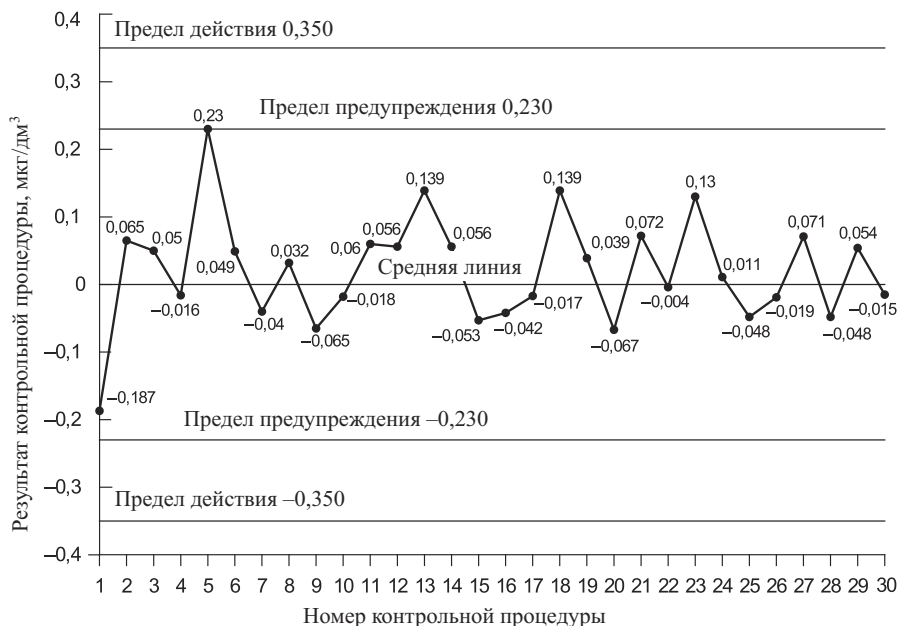
Рис. 1.17. Карта Шухарта для контроля погрешности результатов анализа с использованием образца для контроля в единицах определяемых содержаний с пятью линиями по результатам определения кадмия в питьевой воде
