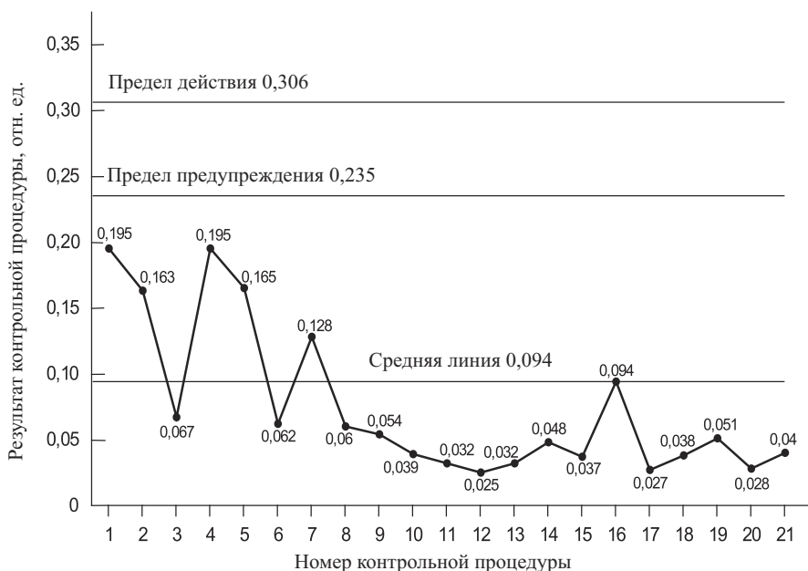
Рис. 1.13. Контрольная карта Шухарта в относительных единицах (отн. ед.) для контроля повторяемости по результатам определения массовой концентрации общего железа в очищенной сточной воде
