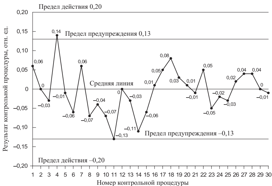
Рис. 1.19. Контрольная карта Шухарта для контроля стабильности погрешности по алгоритму с использованием метода разбавления совместно с методом добавок (в относительных величинах) по результатам определения общего железа в очищенной сточной воде
