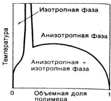
Рис. 48. Диаграмма состояния раствора жесткоцепного полимера (по П. Флори)
