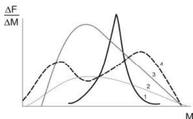
Рис. 12. Типичные кривые ММР: 1 – узкого; 2 – очень широкого; 3 – широкого; 4 – бимодального молекулярно-массового распределения
