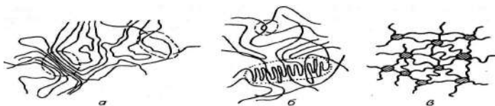
Рис. 27. Схема строения флуктуационных сеток: а – ассоциат с параллельной укладкой сегментов; б – ассоциат складчатый; в – схема флуктуационной сетки с проходными молекулами, соединяющими узлы сетки
