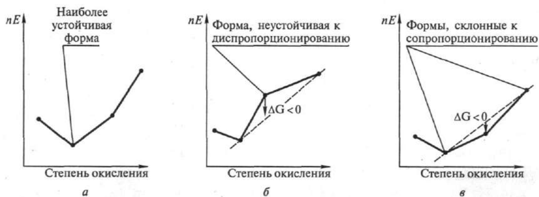
Рис. 20. Схемы диаграмм Фроста, иллюстрирующие наиболее стабильные окислительные формы (а), склонные к реакции диспропорционирования (б), и формы, склонные к реакции сопропорционирования (в)
