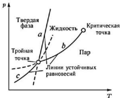
Рис. 6.4. Фазовая диаграмма однокомпонентной системы
