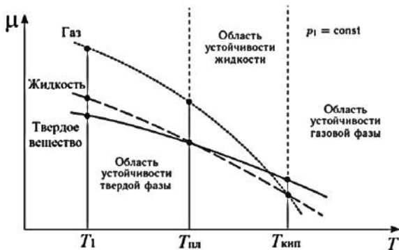
Рис. 6.3. Температурные зависимости химических потенциалов фаз
