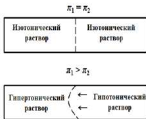
Рис. 4.1. Схема возникновения и проявления осмотического давления в растворах
