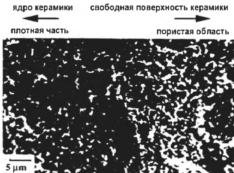
Рис. 24.20. Изменение микрограммы контуров наночастиц LZO при спекании в течении 15 час при T=1425^\circ\text{C}
