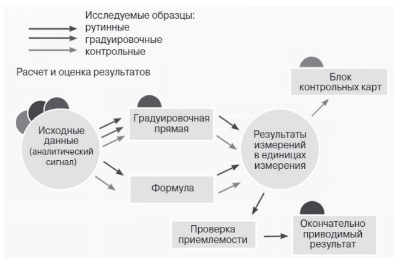
Рис. 4.12. Блок-схема работы Лабораторного журнала программы QControl
