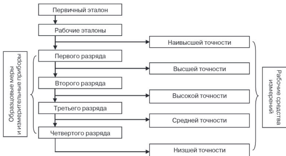
Рис. 1.1. Схема передачи размера от первичного эталона к другим средствам измерений
