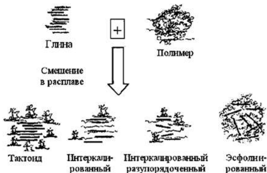
Рис. 10.1. Схематическая иллюстрация терминологии, применяемой при описании структуры нанокомпозитов полимер/органоглина [1]
