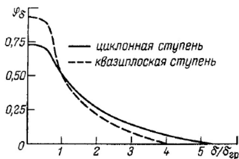
Рис. 2.4.4. Опытные кривые разделения классификаторов среднеходной мельницы с циклонной и квази-плоской вторыми ступенями классификации.
