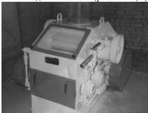
Рис. 1.1.40. Валковая мельница (общий вид).
