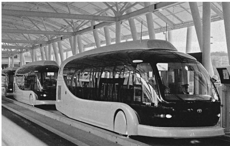
Рис. 4.123. Конструкция несущего корпуса автобусов интеллектуальной транспортной транзитной системы ( Intelligent Multimode Transit Systems, IMTS, Expo-2005 , Япония, фирма Toyota ) из углепластика [143]
