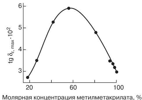
Рис. 2.26. Зависимость \text{tg } \delta_{\epsilon, \text{max}} дипольно-сегментальных потерь для сополимеров метилметакрилата и стирола от содержания метилметакрилата; f = 20 Гц [10].
