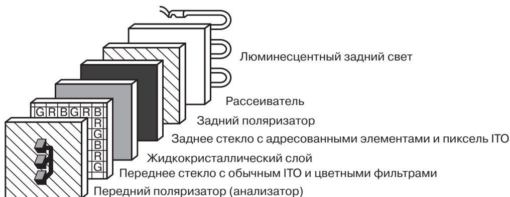
Рис. 1.37. Схема жидкокристаллического дисплея LCD (принцип работы см. текст) [92]
