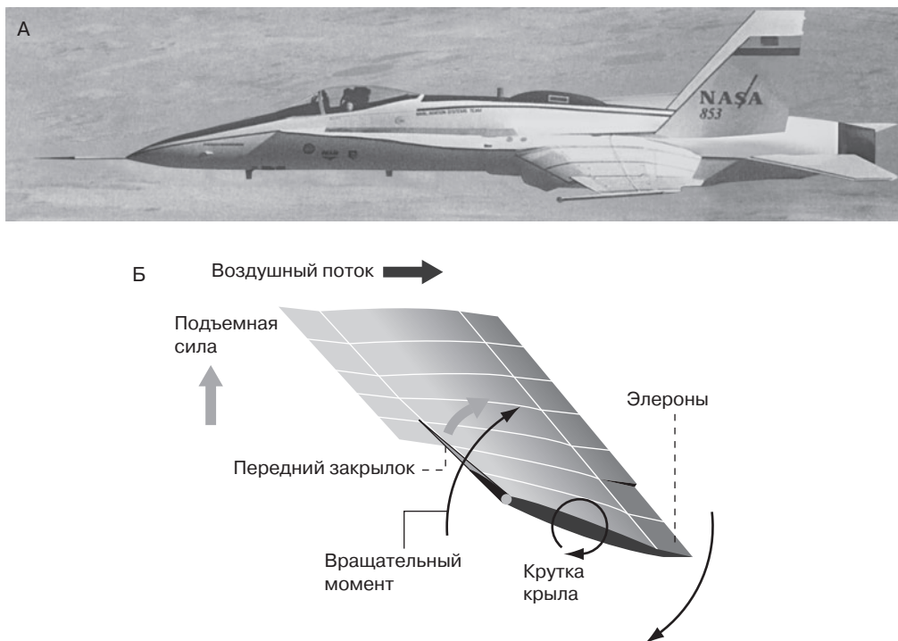
Рис. 1.62. Самолет F/A-18A с активным аэродинамическим крылом (А, ноябрь 2002 г., передняя кромка крыла отклонена вниз) и схема (Б) его работы [105]
