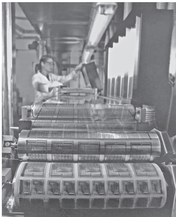
Рис. 1.25. Установка для непрерывной печати изделий полимерной электроники [126]
