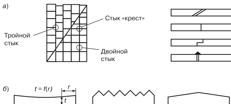
Рис. 3.8. Различные конфигурации керамических элементов брони [1, 2]: а — стыков; б — формы передней поверхности керамических бронезащитных элементов
