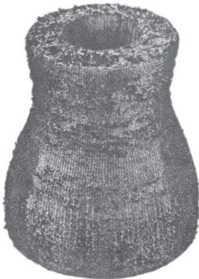
Рис. 5.31. Полуфабрикат (каркас из углеродных нитей) — наполнитель для изготовления раструба из УУКМ [14]
