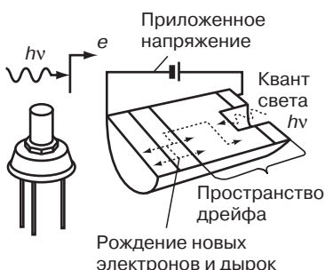
Рис. 1.8. Схемы излучателей и приемников оптического излучения [35]
