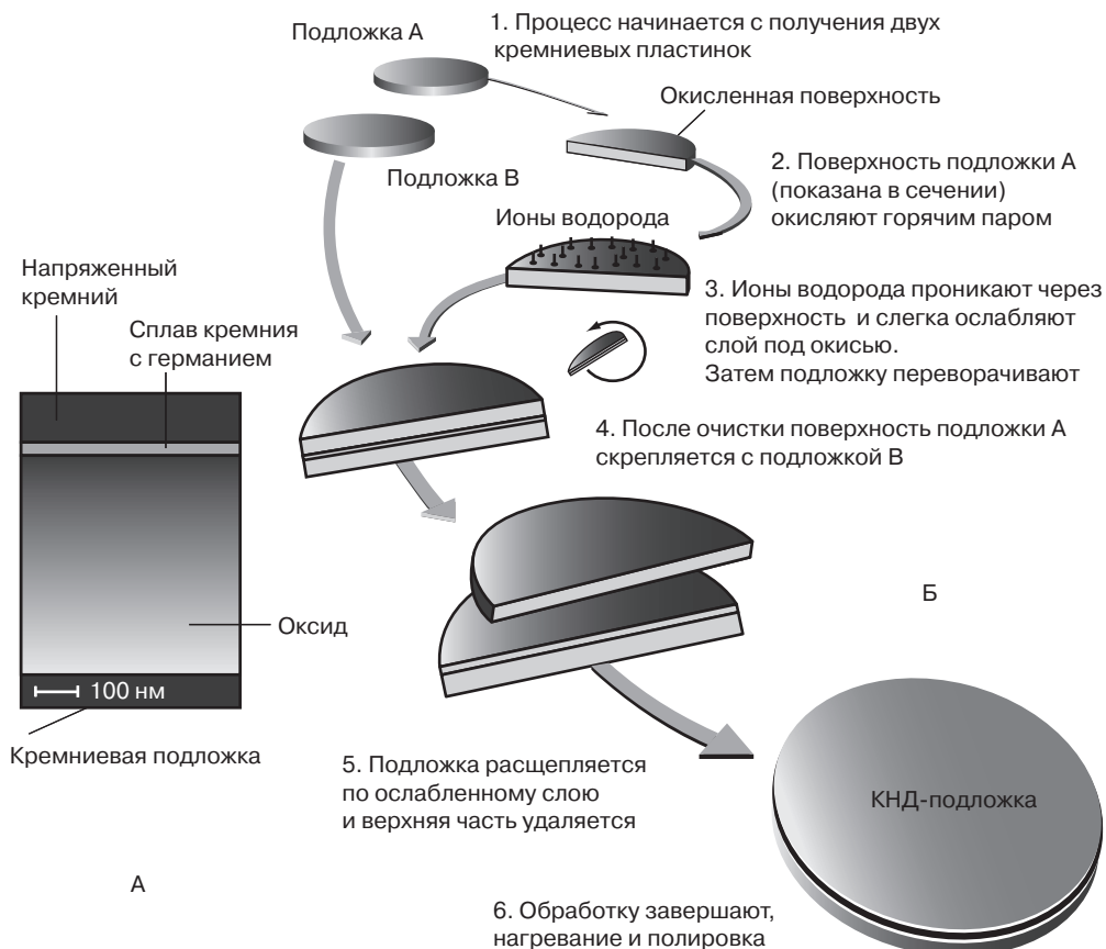
Рис. 1.49. Структура кремниевой подложки, изготовленной по технологии КНД (кремний на диэлектрике) и метода SIMOX (А) и технология точного формирования слоев Smart-Cut (Б) [48].
