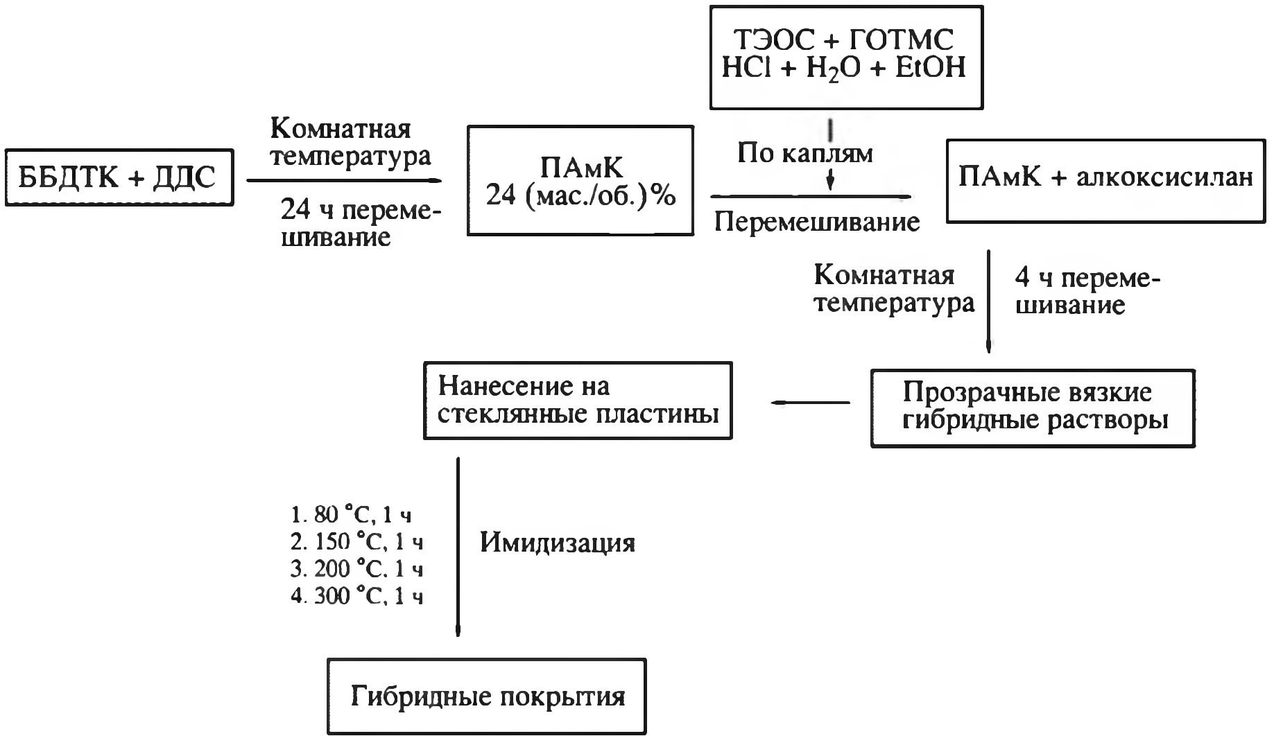
Рис. 3.17. Схема получения ПИ гибридного материала на основе полиамидовой кислоты (ПАмК)-3,3(4,4(-бензофенон диангидрида тетракарбоновой кислоты (БДТК) и 3,3'-диаминодифенилсульфона (ДДС)-SiO 2 в N -метил-2-пирролидоне
