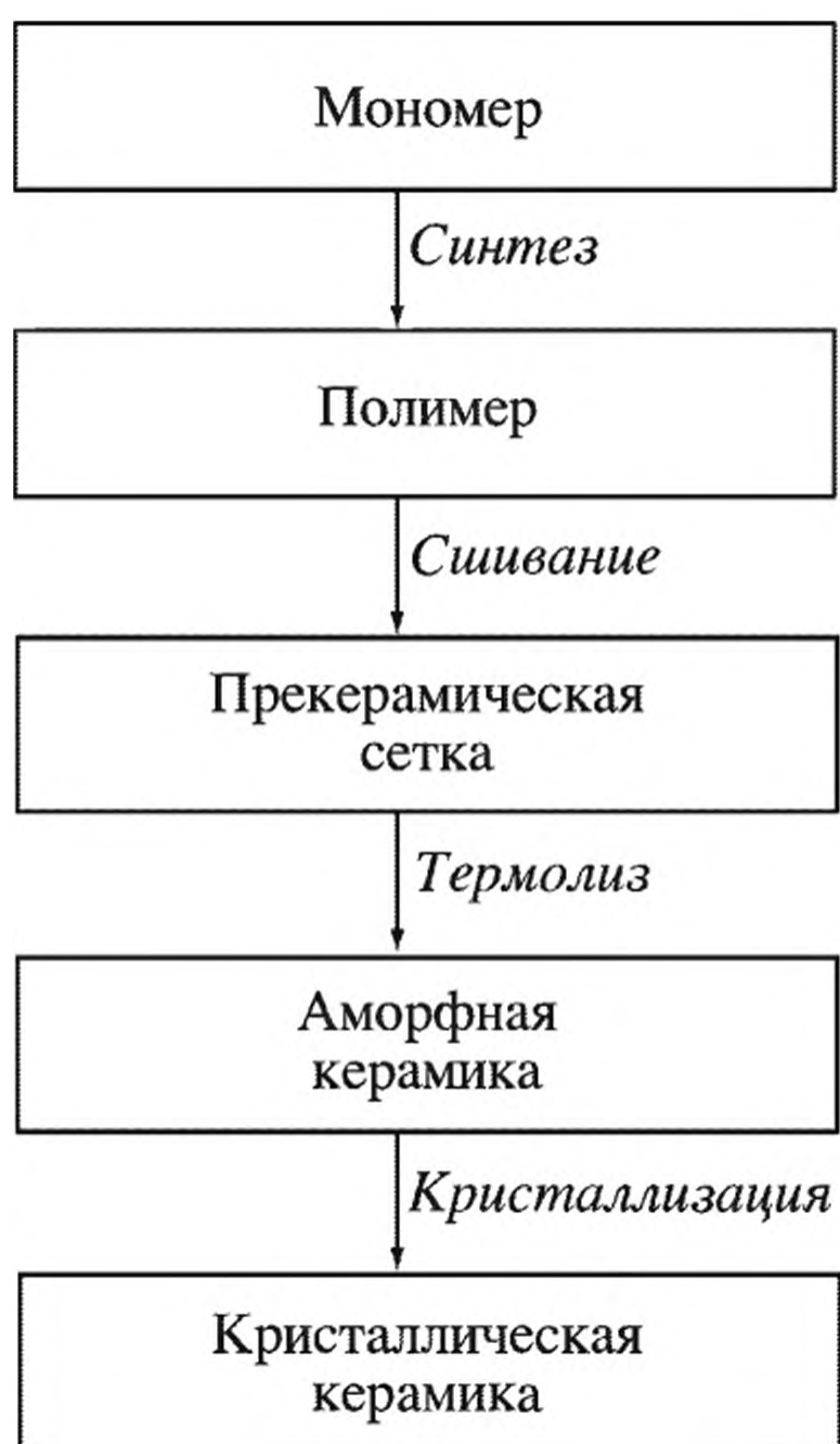
Рис. 3.11. Получение нанокompозитов путем сополимеризации преполимеров
