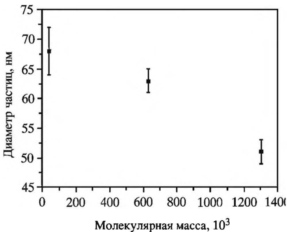
Рис. 1.22. Зависимость размера наночастиц Ni от молекулярной массы поли(N-винилпирролидона)
