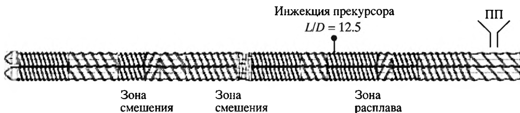
Рис. 3.14. Профиль шнека и точки локализации инъекции \text{Ti}(\text{OBu})_4
