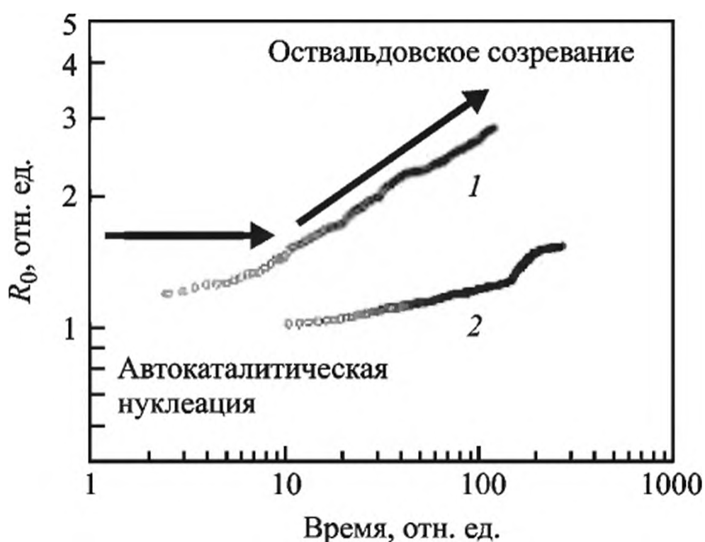
Рис. 2.4. Зависимость среднего радиуса ( R_0 ) металлических наночастиц Pd (1) и Rh (2) от времени фотооблучения
