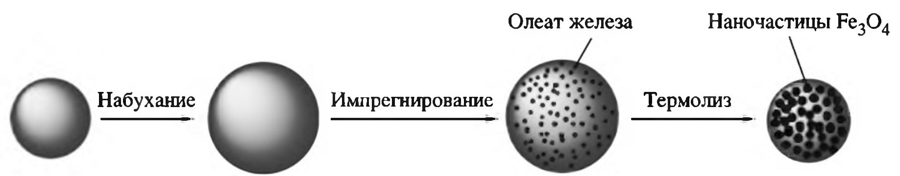
Рис. 5.26. Схема получения монодисперсных магнитных микросфер техникой набухания и термолиза
