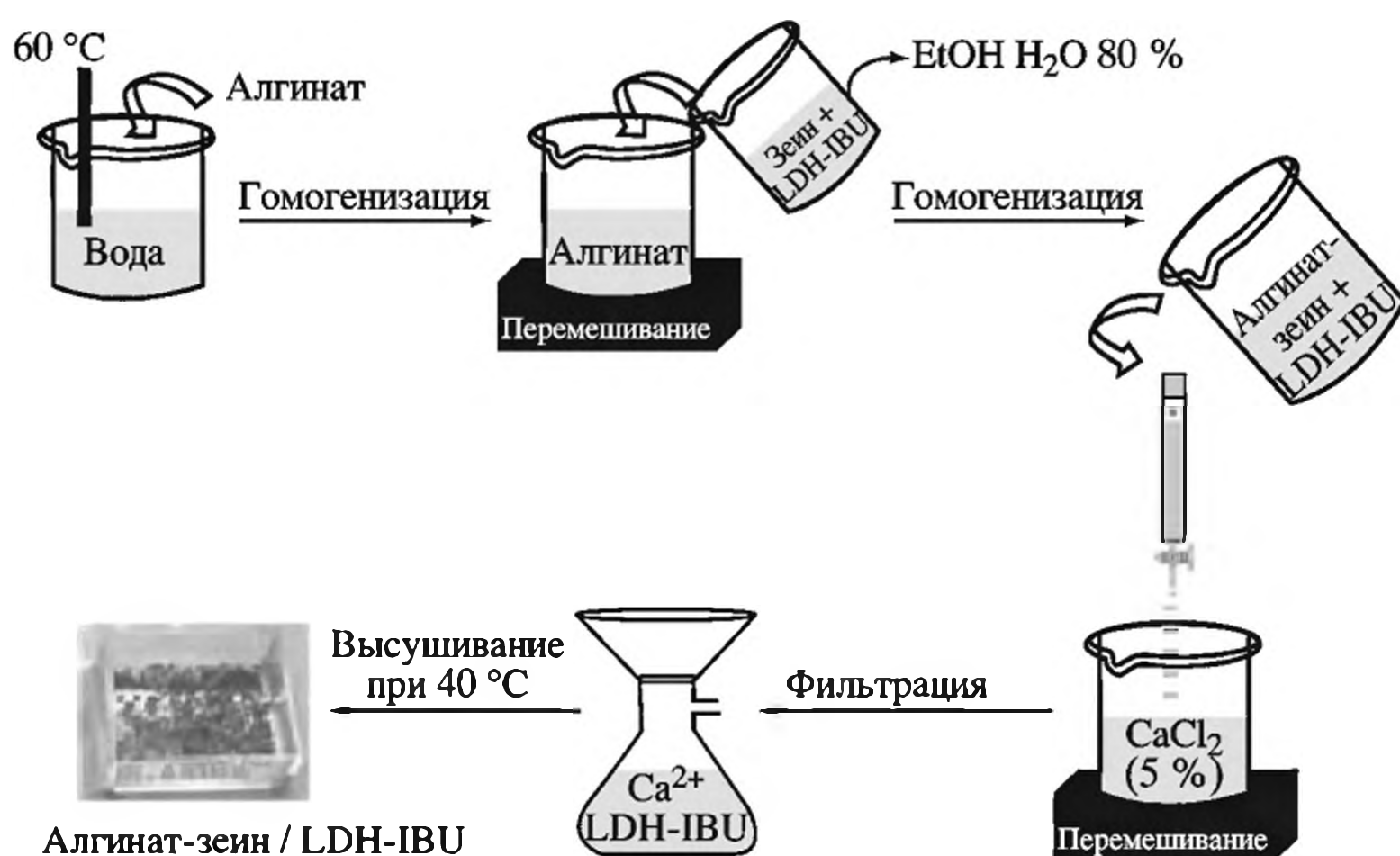
Рис. 6.10. Схема получения альгинат-зеиновых препаратов, включенных в гибридные шарики LDH-IBU
