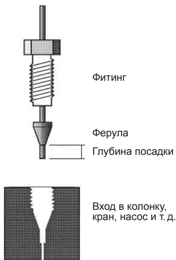
Рис. 4.4. Соединения для повышенных давлений
