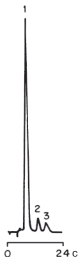
Рис. 23.3. Высокоскоростное разделение гипотензивного лекарственного препарата (с разрешения F. Erni, Novartis). Условия: образец — 10 мкл раствора капсулы в искусственном желудочном соке, колонка 100 \times 2,1 мм, сорбент Spherisorb RP-18, 5 мкм, подвижная фаза ацетонитрил — 0,4 М фосфорная кислота (85:15), скорость потока 3 мл/мин, УФ, 260 нм, объем ячейки детектора 2,8 мкл, длина оптического пути 10 мм, постоянная времени 0,1 с (98 %). Пики: 1 — клопамид, 2 — дигидроэргокристин, 3 — резерпин
