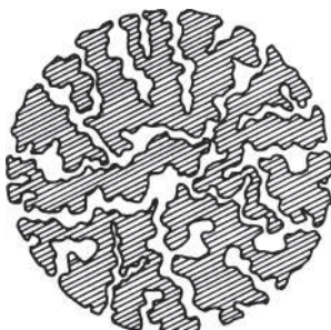
Рис. 2.5. Пористая структура частицы сорбента
