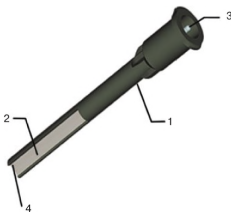
Рис. 2. Композитный углеродсодержащий электрод, изготовленный по методике «литье под давлением» (Томск, ООО «Томьаналит»): 1 — полиэтиленовый корпус, 2 — электропроводящая смесь термостабилизированного полиэтилена высокого давления (70%) и технического углерода марки N220 (30%), 3 — контакт, 4 — рабочая поверхность
