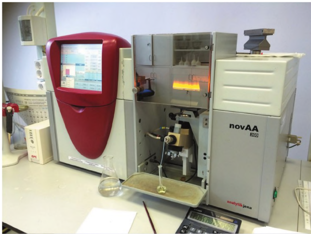
Атомно-абсорбционный (ААА) спектрометр «novAA-330» с пламенным атоизатором (производство Analytik Jena, Германия)
