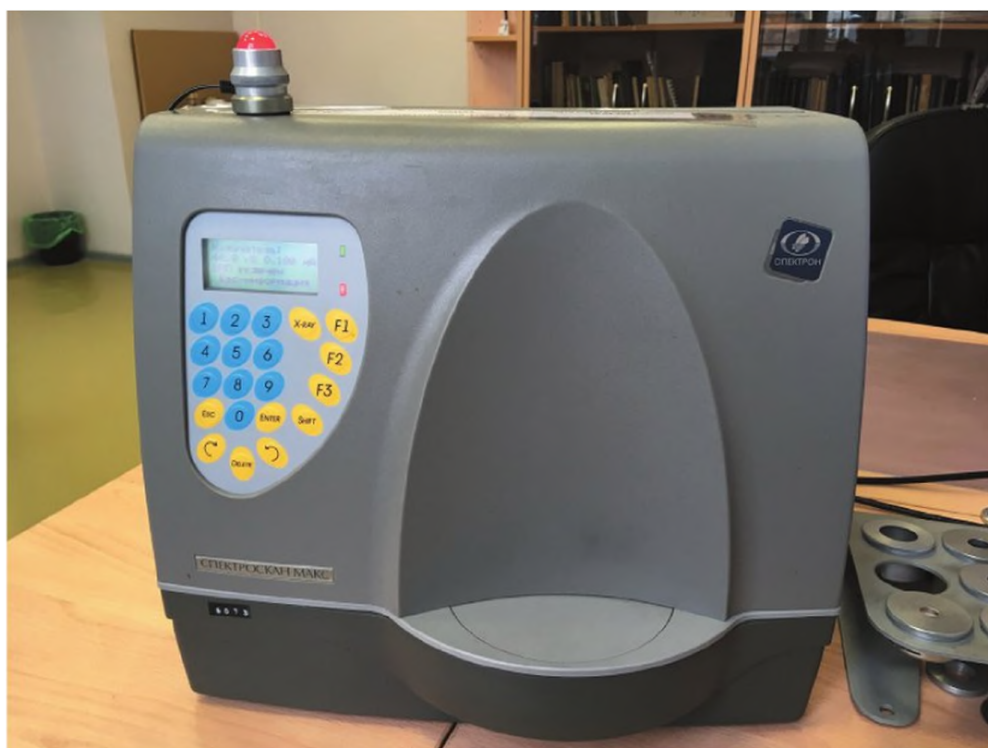
Энергодисперсионный спектрометр «Спектроскан «МАКС-G» (производство ООО «НПО «Спектрон», г. Санкт-Петербург)
