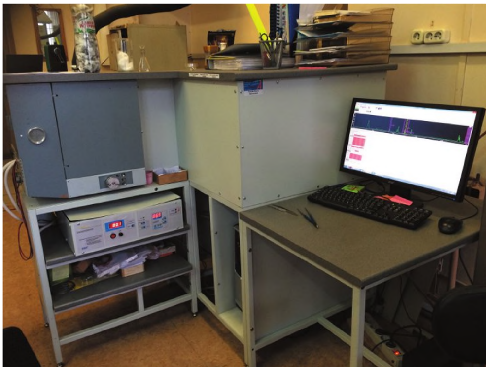
Атомно-эмиссионный спектрометр СПАС-01 с дуговым возбуждением спектра. В качестве источника возбуждения спектров использовался генератор дуги постоянного или переменного тока с силой до 15 А
