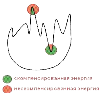
Рис. 6.4. Сечение поверхности адсорбента
