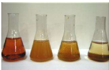
Рис. 8.2. Стадии коагуляции золя гидроксида железа (III)
