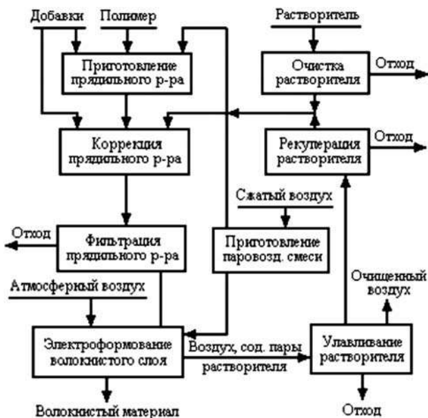
Рис. 30 Технологическая схема ЭФВ-процесса
