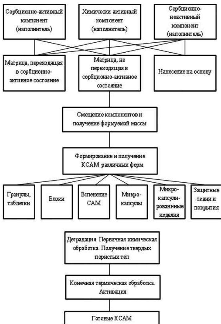
Рис. 38 Принципиальная схема получения композиционных сорбционно-активных материалов
