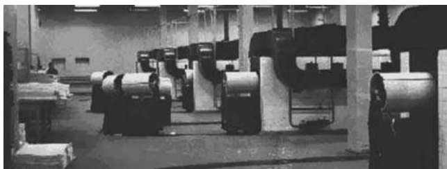
Рис. 36 Съем готовой продукции с барабанных электродов
