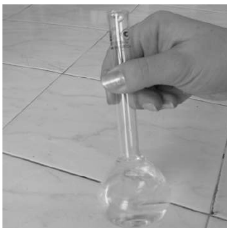
Рис. 57. Растворение кристаллов фармацевтической субстанции в мерной колбе № 1
