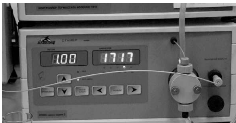
Рис. 348. Параметры хроматографирования: заданная скорость подачи элюента — 1 мл/мин и параметр давления — 1717 psi. Длина волны 230 нм
