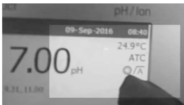
Рис. 149. Завершение процесса калибровки прибора по первому калибровочному раствору с pH 7,0
