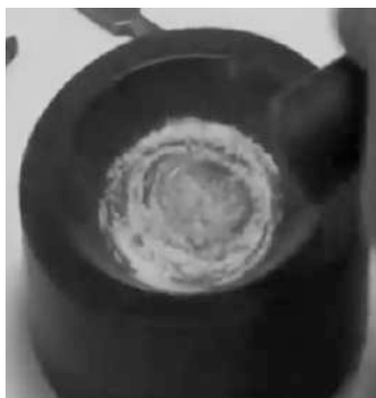
Рис. 78. Растирание анализируемого вещества с индифферентными веществами субстанциями калия бромида или калия хлорида
