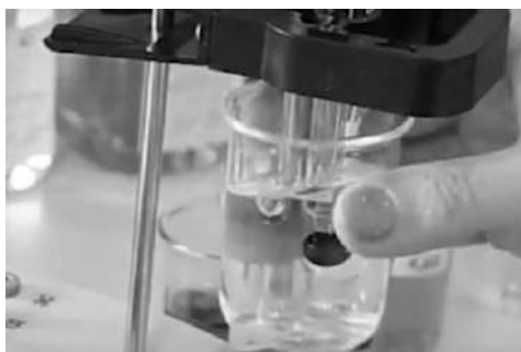
Рис. 130. Смыв с электродов первого калибровочного раствора
