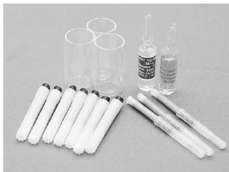
Рис. 234. Набор для определения катионов железа
