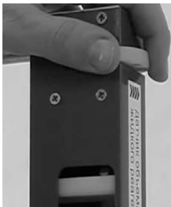
Рис. 199. Подведение толкателя к поршню шприца инъекционного
