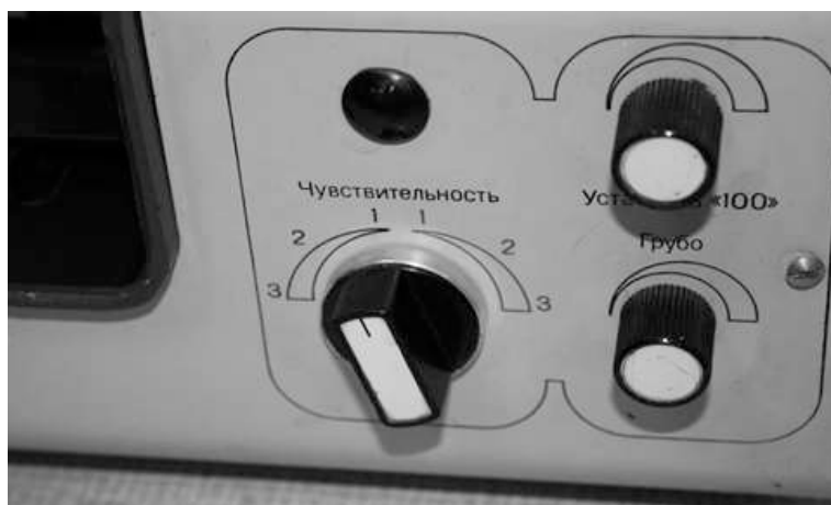
Рис. 32. Установка минимальной чувствительности фотоэлектроколориметра по двум тумблерам: «чувствительность» на единицу слева и «установка „100“» в крайне левое положение (в положение «грубо»)
