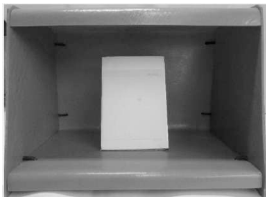
Рис. 313. Камера для опрыскивания хроматографических пластин для детектирования веществ, не имеющих собственной окраски
