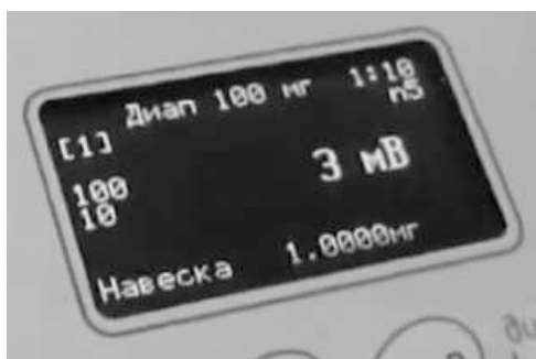
Рис. 178. Отображение информации о электрическом потенциале системы
