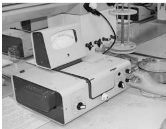
Рис. 37. Установка нулевого значения оптической плотности
