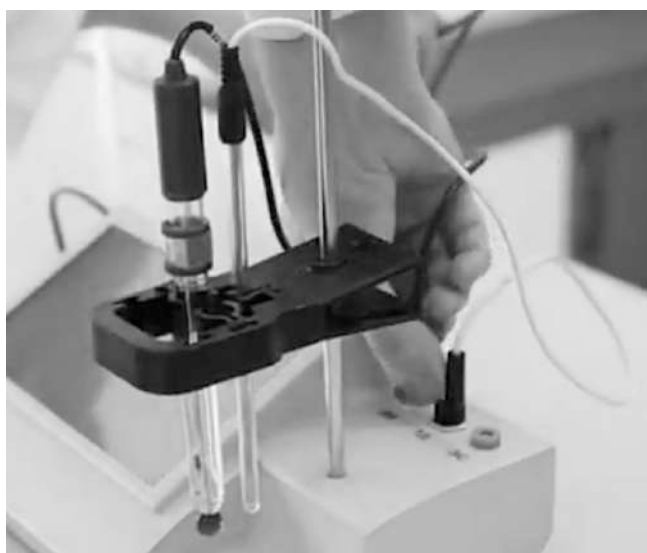
Рис. 121. Фиксация измерительного электрода в лапке держателя и подключения его к гнезду
