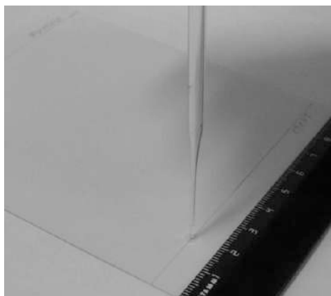
Рис. 310. Нанесение раствора анализируемого вещества на линию старта
