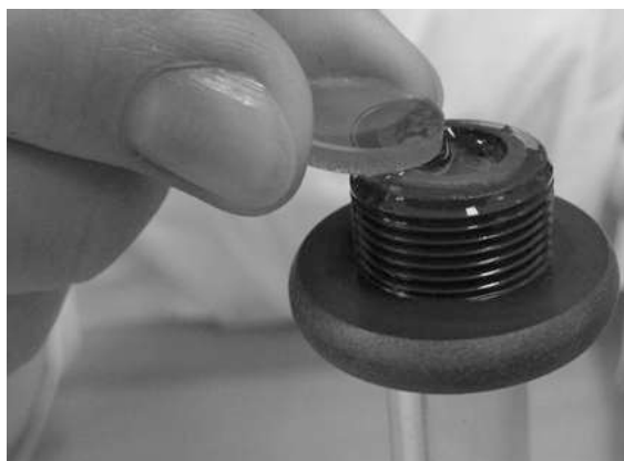
Рис. 19. Надвигание стекла на торец трубки для фиксации столба анализируемого раствора
