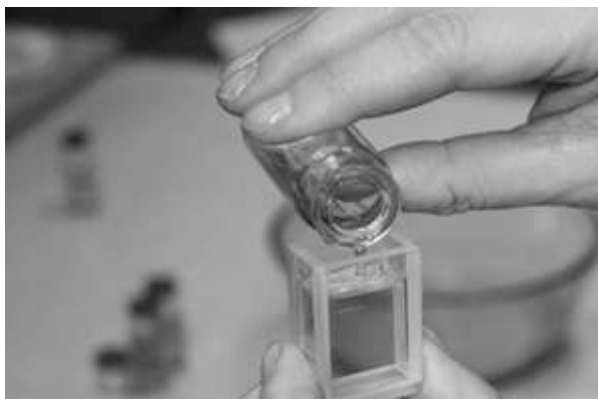
Рис. 27. Заполнение кюветы исследуемым раствором перед анализом
