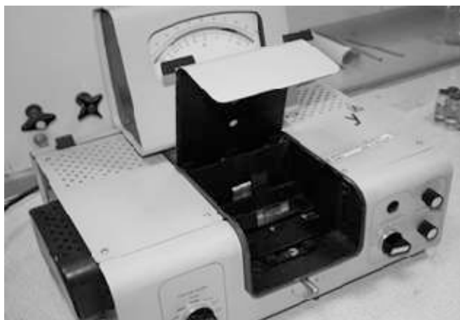
Рис. 23. Фотоэлектроколориметр (на примере фотоэлектроколориметра марки ФЭК-56М) включают в розетку и дают прогреться при открытой крышке кюветного отделения
