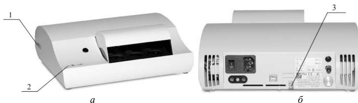
Рис. 225. Места от несанкционированного доступа на анализаторе вольтамперометрическом ТА-Lab:
