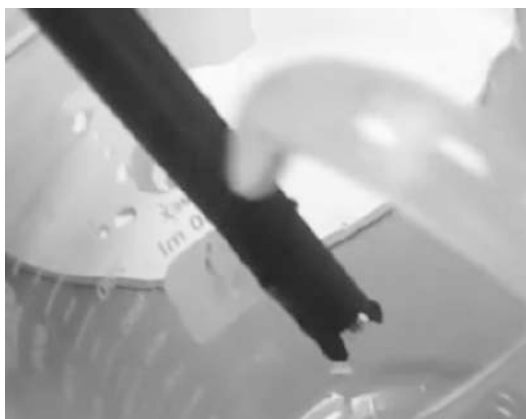
Рис. 144. Промывка рН-электрода водой дистиллированной от 3 моль/л раствора калия хлорида
