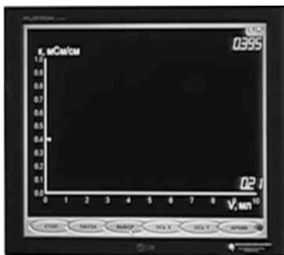
Рис. 211. Фиксация точки нулевого объёма титранта
