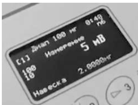
Рис. 180. Конец титрования контрольной пробы воды
