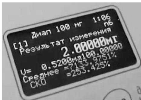
Рис. 183. Отображение итоговой информации по анализу контрольного образца воды
