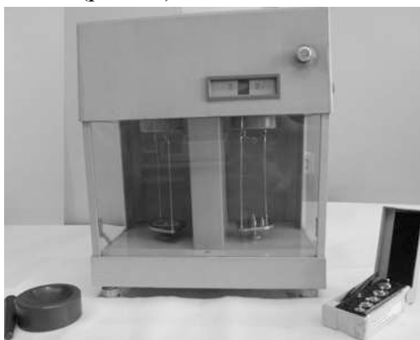
Рис. 99. Взвешивание анализируемой субстанции на аналитических весах
