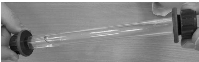
Рис. 16. Промывание кюветы поляриметра анализируемым раствором
