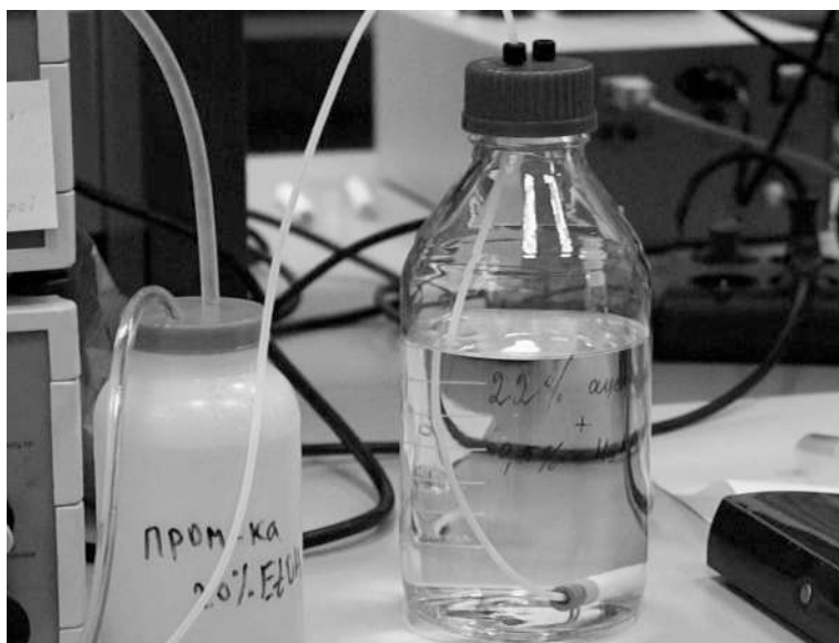
Рис. 347. Флакон с элюентом — 22%-ным раствором ацетонитрила
