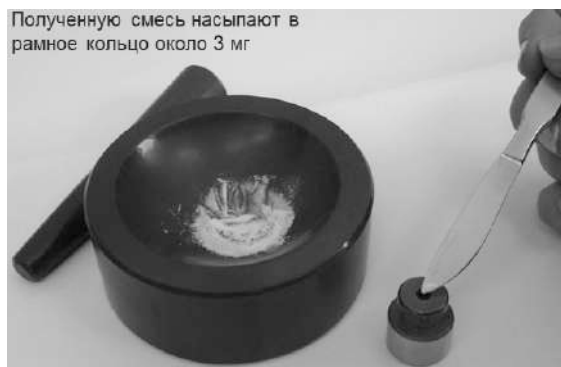
Рис. 95. Заполнение рамного кольца смесью спектрофотометрирования
