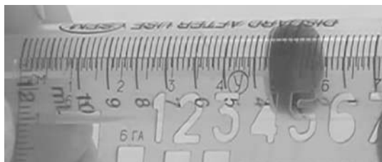
Рис. 196. Измерение длины шкалы шприца инъекционного
