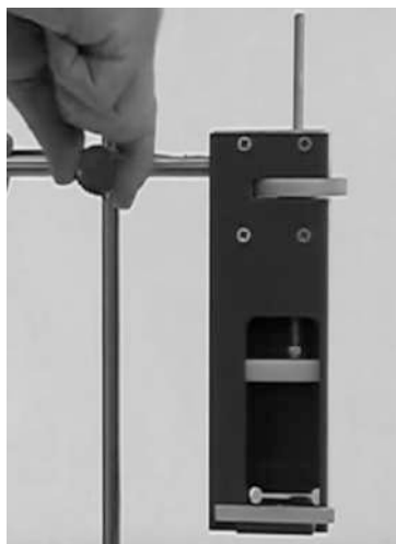
Рис. 192. Фиксация датчика объёма жидкого реагента
