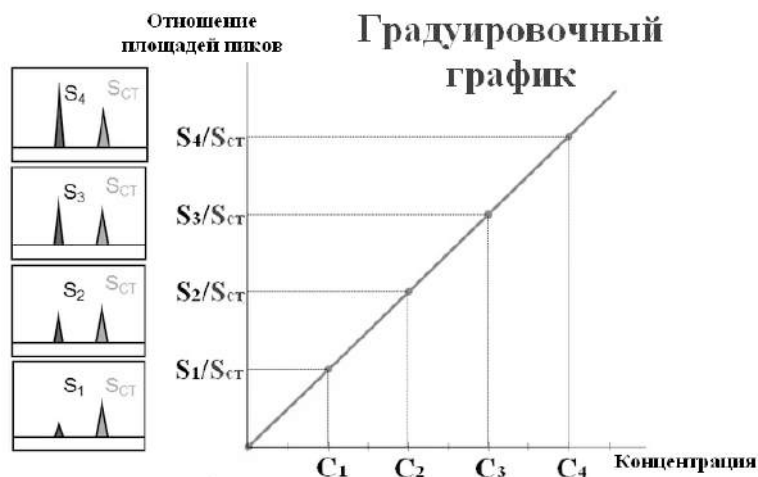
Рис. 342. Вид графика при количественном определении методом внутреннего стандарта
