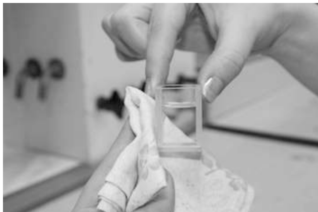
Рис. 30. Удаление мешающих следов со стенок кюветы сравнения безворсовой салфеткой
