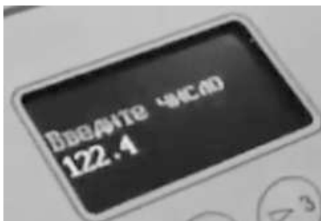
Рис. 184. Ввод массы анализируемого образца
