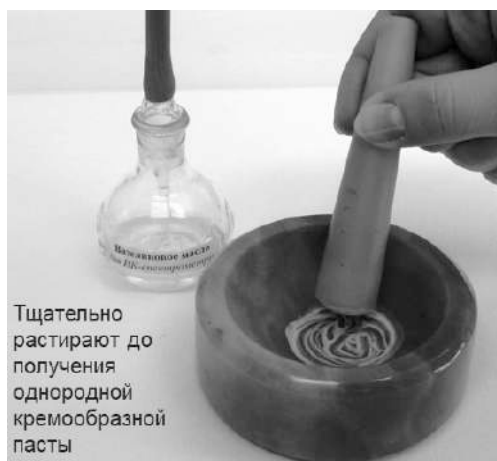
Рис. 102. Получение пастообразной массы анализируемого вещества с вазелиновым маслом
