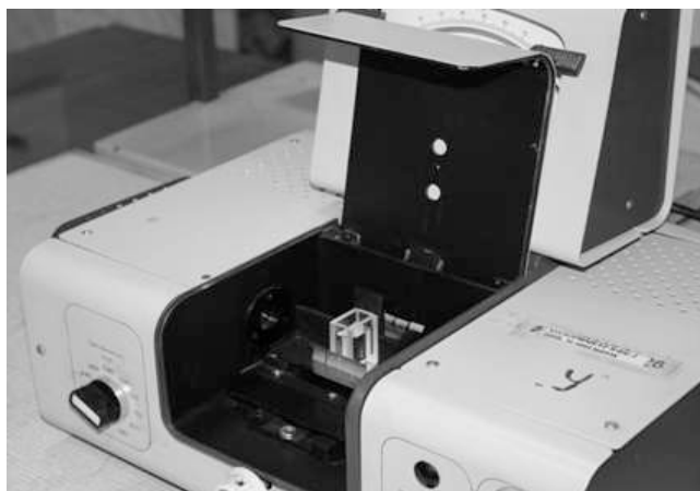
Рис. 33. Раствор сравнения или вода очищенная в кювете помещается напротив светового потока
