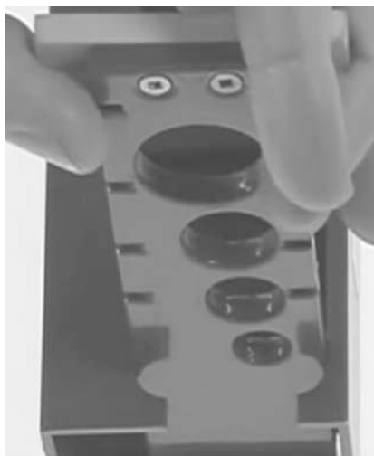
Рис. 197. Снаряжение датчика объёма жидкого реагента шприцем с раствором титранта
