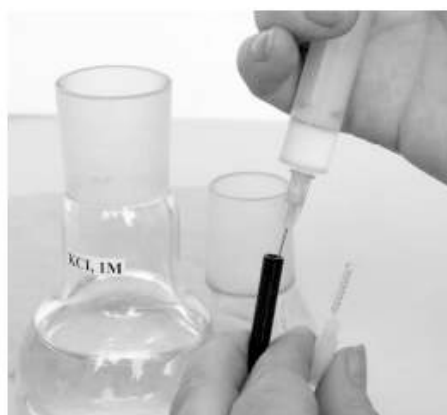
Рис. 237. Наливка раствора калия хлорида в корпус хлорсеребряного электрода
