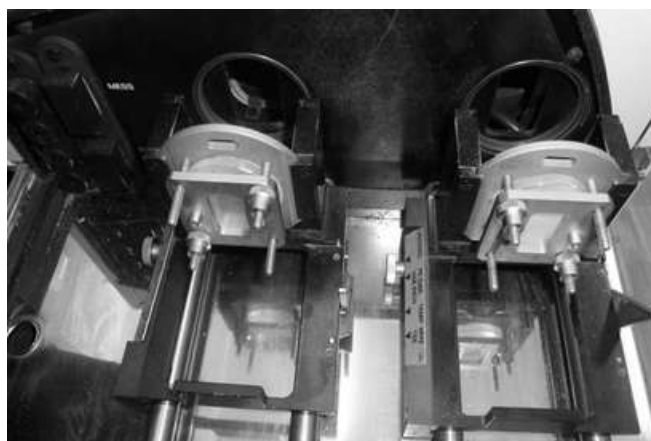
Рис. 105. Разборная кювета с пластинами помещена в ИК-спектрофотометр
