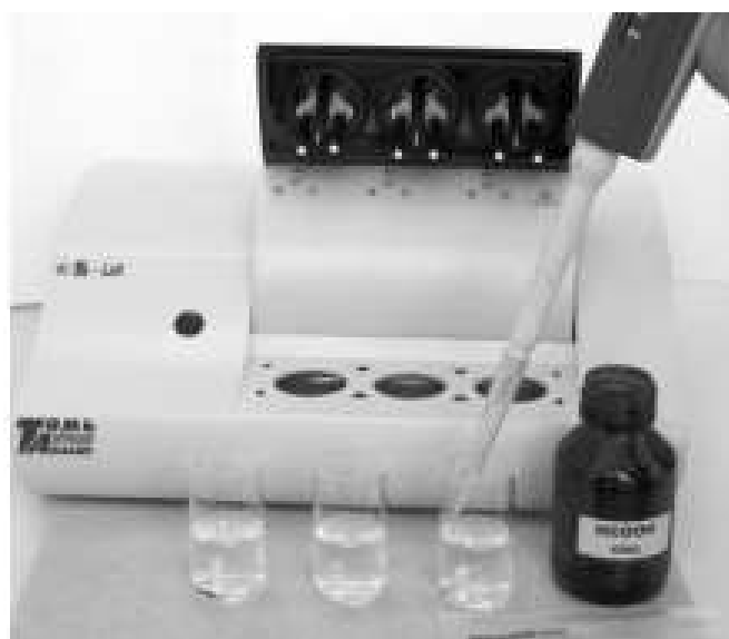
Рис. 240. Первый этап подготовки отмывки электрохимических ячеек
