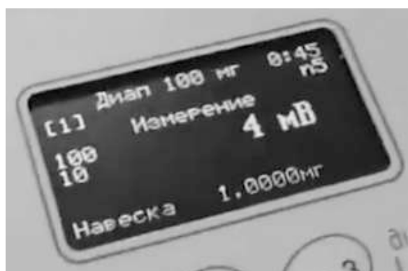
Рис. 172. Добавление раствора титранта и снижение электролитического потенциала смеси в ячейке
