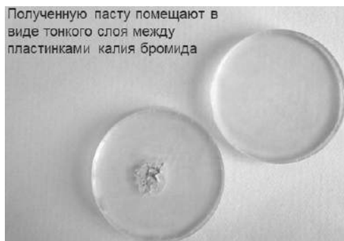
Рис. 103. Паста с анализируемым веществом помещается между пластинами калия бромида или натрия хлорида
