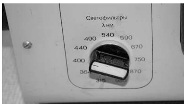
Рис. 31. Установка тумблера на нужную длину волны в соответствии с длиной волны анализируемого вещества, при которой устанавливается максимальная оптическая плотность раствора анализируемого вещества
