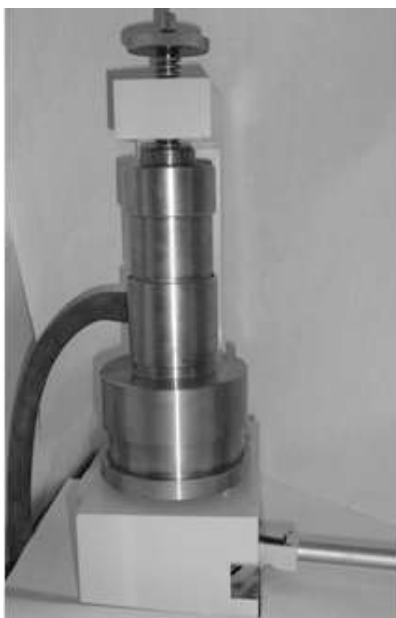
Рис. 96. Пресс-форма для получения таблетки калия бромиды или натрия хлорида с субстанцией анализируемого вещества
