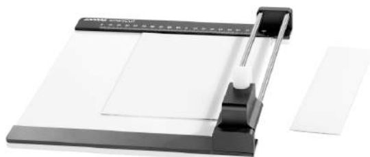
Рис. 260. Резатель тонкослойных и высокоэффективных тонкослойных пластин со стеклянной подложкой
