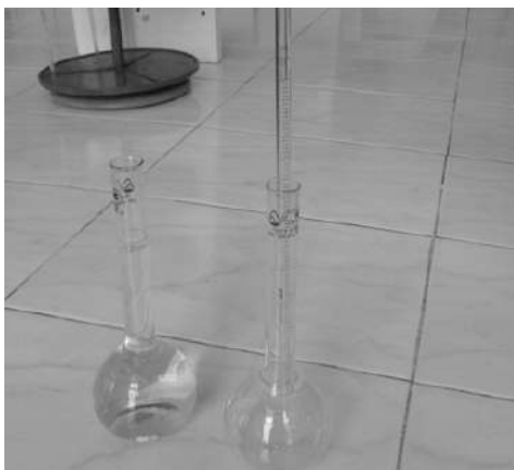
Рис. 59. Перенос части раствора из мерной колбы № 1 в мерную колбу № 2 для получения разведения
