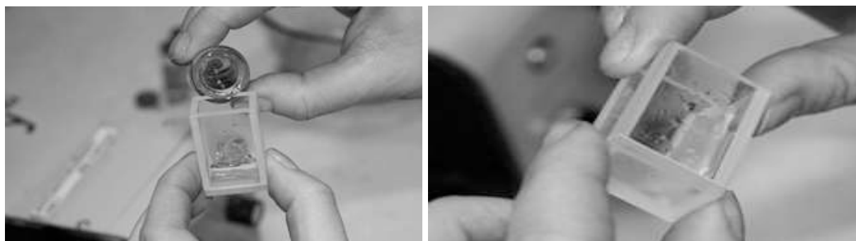
Рис. 25. Промывка кюветы исследуемым раствором: а — наливание анализируемого раствора в кювету; б — споласкивание кюветы анализируемым раствором.
