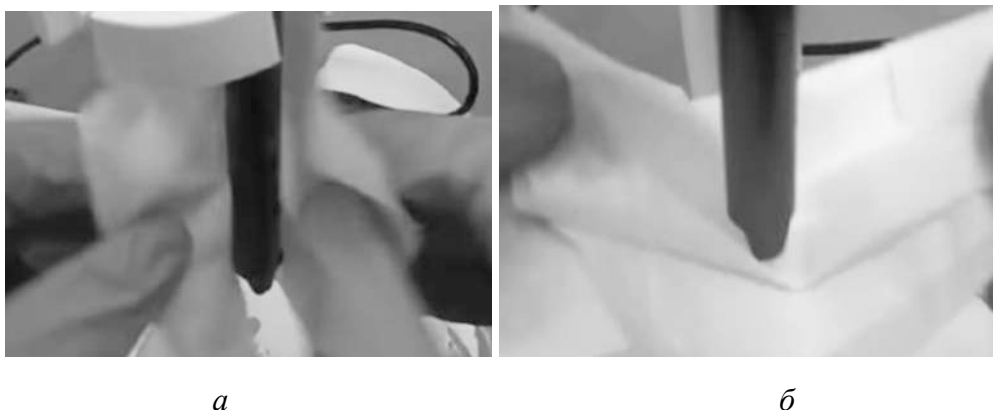
Рис. 145. Удаление сухой безворсовой салфеткой воды очищенной с рН-электрода: а — вертикальное удаление; б — горизонтальное удаление.
