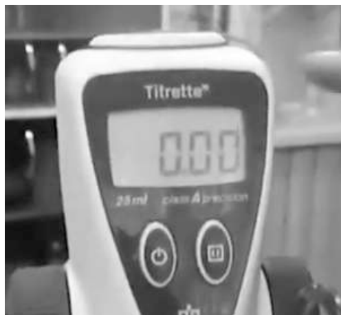
Рис. 170. Обнуление показателя в мл на электронной бюретке
