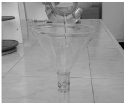
Рис. 60. Через воронку ко взятой аликвоте прибавляют растворитель в мерной колбе № 2
