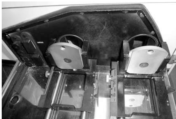
Рис. 98. Размещение рамного кольца с таблеткой в ИК-спектрофотометр
