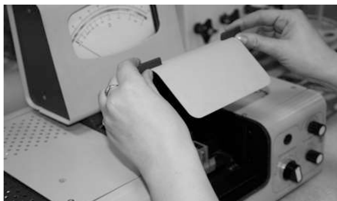
Рис. 35. Закрывается крышка кюветного отделения фотоэлектроколориметра
