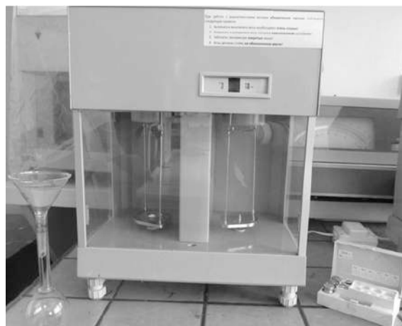
Рис. 54. Аналитические весы, разновес и мерная колба для приготовления раствора фармацевтической субстанции для разведения
