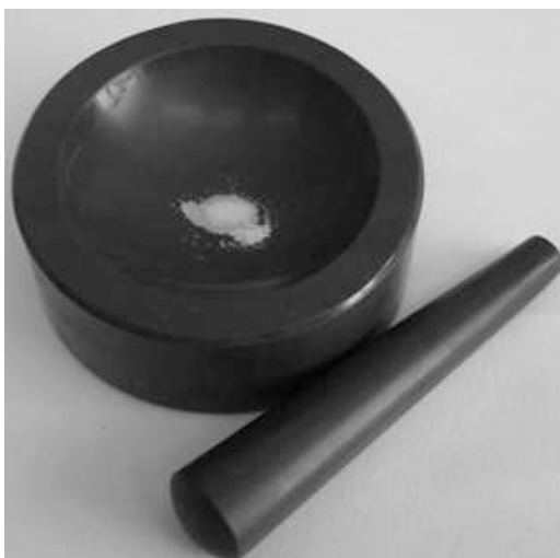
Рис. 93. Анализируемая субстанция в агатовой ступке совместно с порошком субстанции калия бромида или натрия бромида
