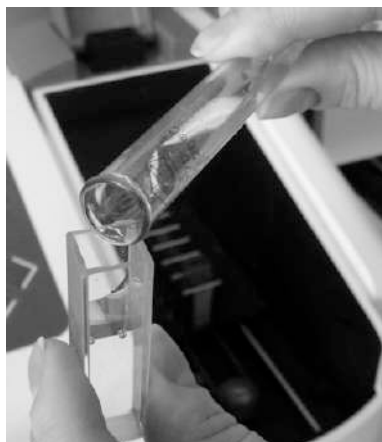
Рис. 61. Заполнение кварцевой кюветы анализируемым раствором из мерной колбы № 2
