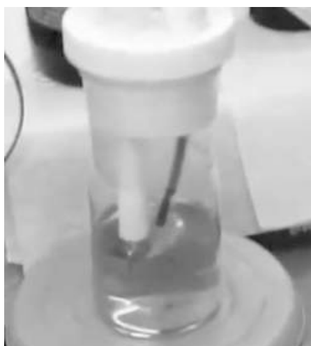
Рис. 166. Потемнение раствора реактива К. Фишера сольвент 800 в ячейке
