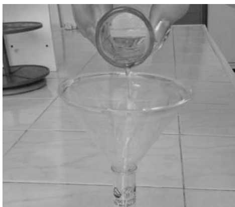
Рис. 56. Приливание растворителя к фармацевтической субстанции в мерной колбе № 1
