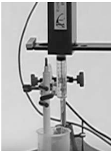
Рис. 201. Регулирование расположения датчика объёма жидкости и шприца над химическим стаканом
