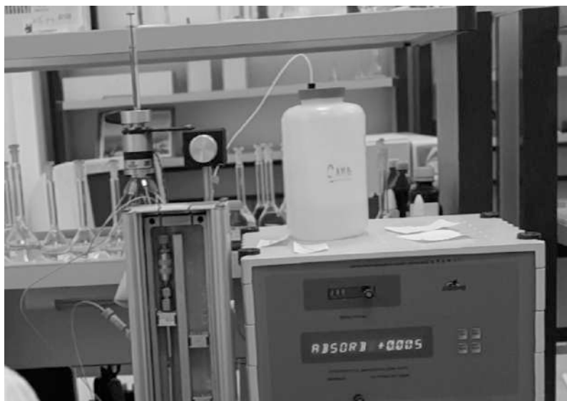
Рис. 345. Вкол раствора стандартного вещества с наименьшей концентрацией после трёхкратной промывки петли. Поворот крана инжектора влево до упора. Шприц остаётся в инжекторе
