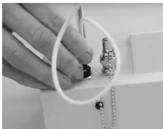
Рис. 119. Подключение термодатчика к разъёму
