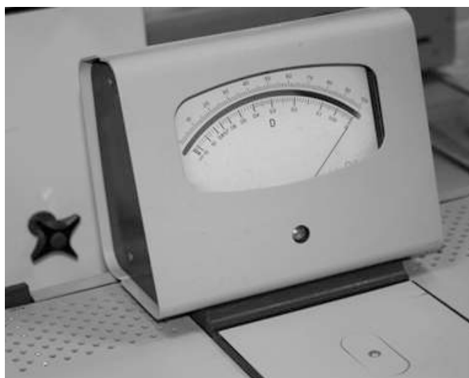
Рис. 38. Нулевое значение оптической плотности относительно раствора сравнения
