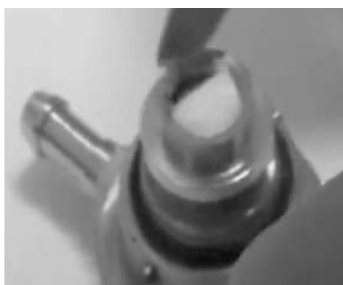
Рис. 79. Собираение смеси и насыпание её в паз пресса
