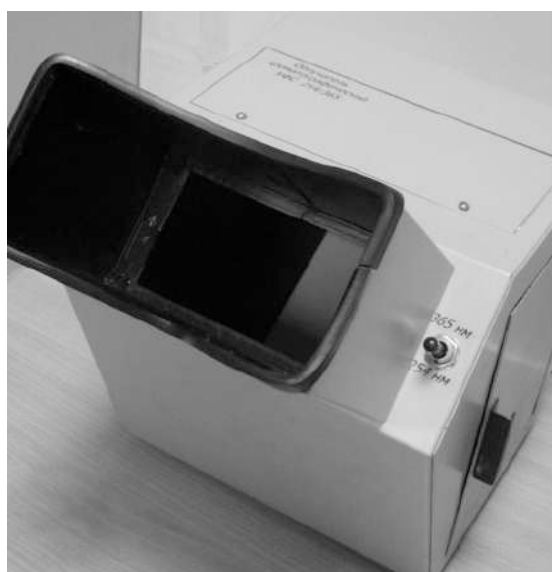
Рис. 312. Хроматографическая камера УФС-254/365 для детектирования флюоресцирующих веществ в ультрафиолетовом свете
