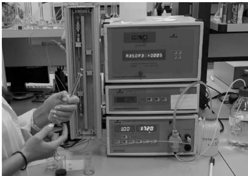
Рис. 343. Набор в хроматографический шприц раствора стандартного вещества с целью промывки петли с наименьшей концентрацией
