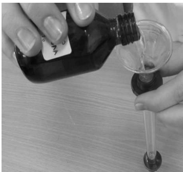
Рис. 17. Заполнение кюветы поляриметра исследуемым раствором
