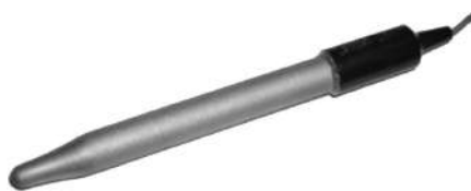
Рис. 109. Платиновый электрод марки ЭТПЛ-01М
