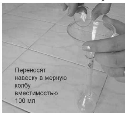
Рис. 55. Перенос фармацевтической субстанции в мерную колбу для растворения
