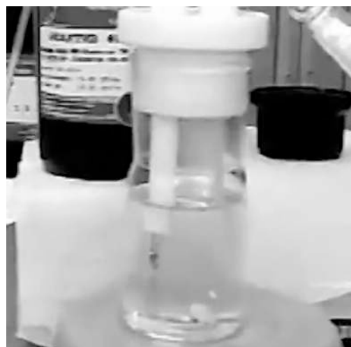
Рис. 158. Размещение пары электродов в среду титрования
