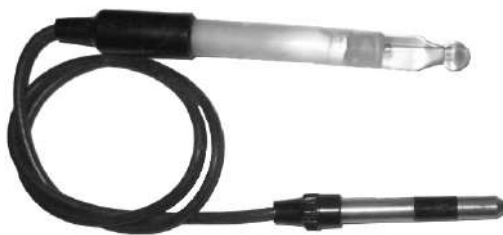
Рис. 112. Стеклянный электрод марки ЭСЛ-11Г-05
