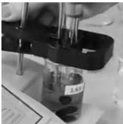
Рис. 126. Начало калибровки с раствора с наименьшим значением pH
