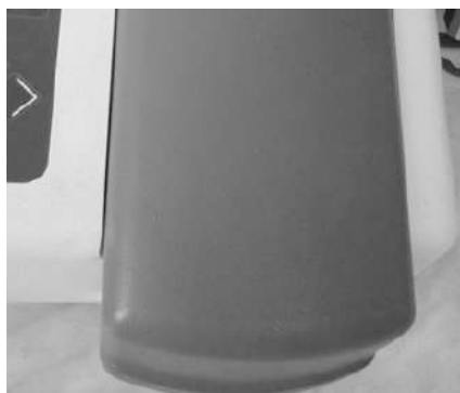
Рис. 63. Кюветное отделение закрыто перед началом анализа
