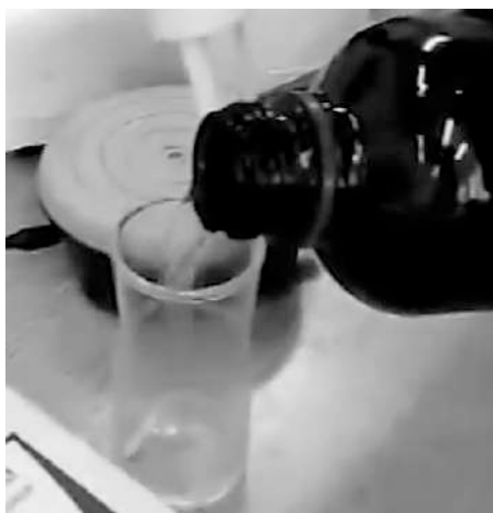
Рис. 157. Заливка электролитической ячейки среды титрования
