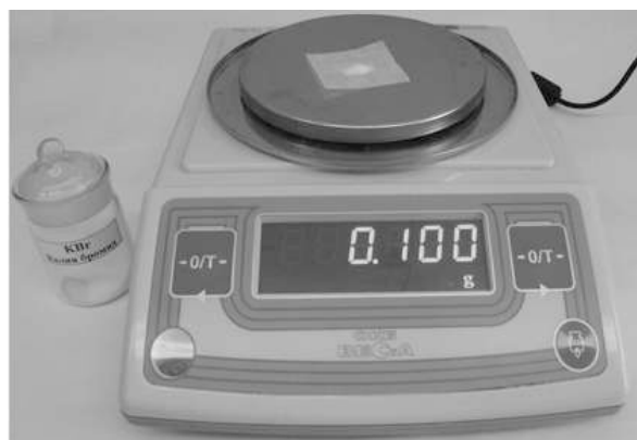
Рис. 91. Взвешивание субстанции калия бромида для подготовки спрессованной таблетки с субстанцией анализируемого вещества
