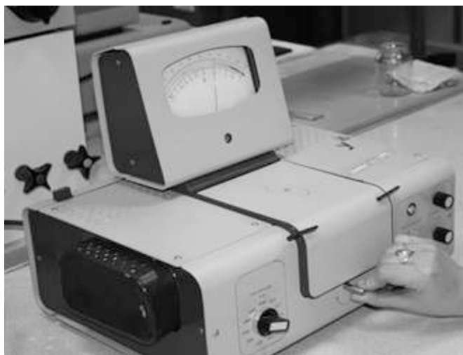
Рис. 39. Снятие показания оптической плотности с анализируемого раствора
