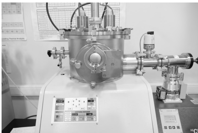
Рис. 4.6. Фотография экспериментальной установки магнетронного распыления для получения нанопорошков и наноструктурированных пленок
