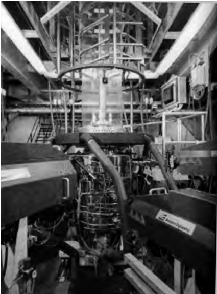
Рис. 3.8. Фотография установки и экструзионной головки для получения рукавным методом девяти-слойной пленки (фотография предоставлена компанией Brampton Engineering ) [12]
