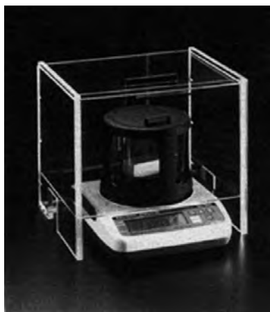
Рис. 2.1. Общий вид прибора, использующегося для измерения значений относительной плотности (удельного веса) (фотография представлена компанией Testing Machines Inc. )
