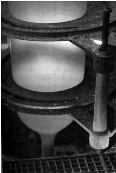
Рис. 3.7. Фотография рукава, получаемого при производстве пленки методом экструзии с последующим раздувом [11]
