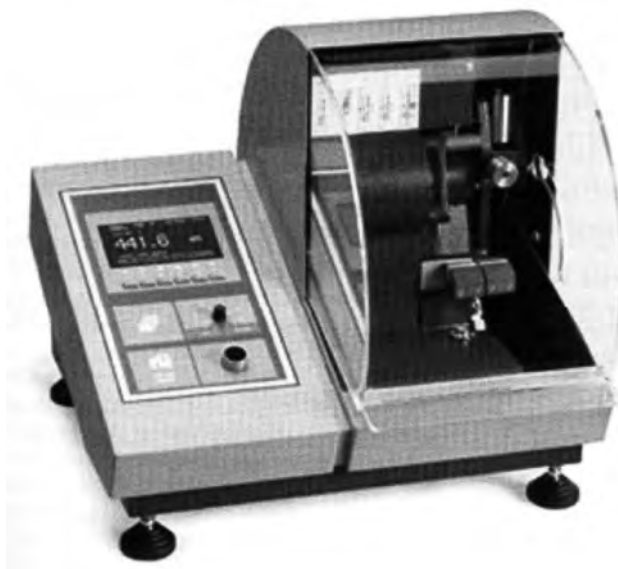
Рис. 2.22. Метод измерения прочности на разрыв по Элмендорфу: схематическое изображение (сверху) и общий вид промышленно используемой установки (снизу) для проведения этого анализа (фотография представлена компанией Testing Machines Inc. )
