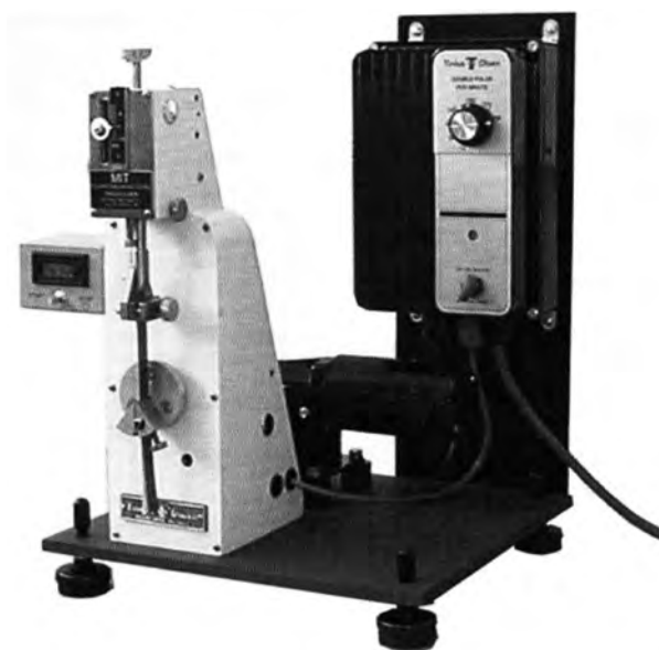
Рис. 2.18. Машина МТИ для определения срока службы при изгибе (фотография предоставлена компанией Testing Machines Inc. )
