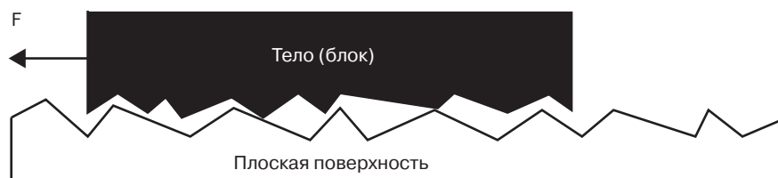
Рис. 2.6. Схема контакта между телом (блоком) и плоской поверхностью на микроскопическом уровне
