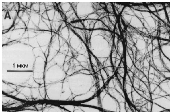
Рис. 3.3. Трансмиссионная электронная микрофотография разбавленной суспензии целлюлозы сахарной свеклы (заимствовано из литературы [20])
