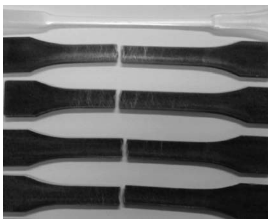
Рис. 7.5. Образцы для проведения испытаний на растяжение композитов на основе ПП и джутового наполнителя, содержащего 0, 6, 12, 18 и 23 %об. джутового наполнителя, согласно данным Кэбрэла и его сотрудников (неопубликованные данные) (содержание волокон в образцах возрастает в направлении сверху вниз)
