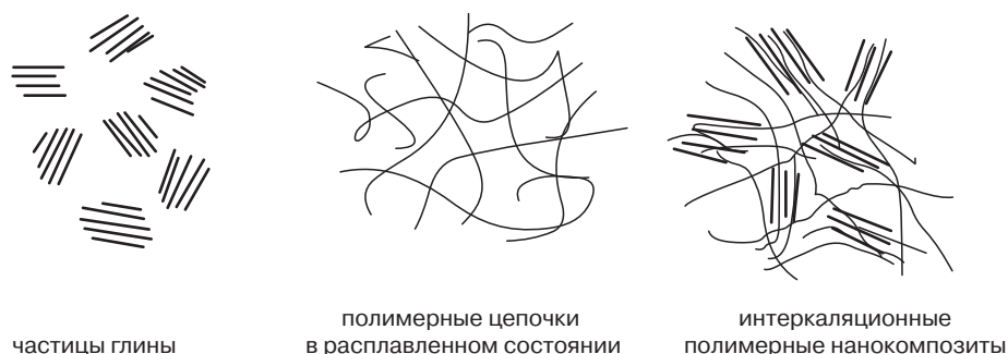
Рис. 12.1. Схематический вид процесса интеркаляции в расплаве
