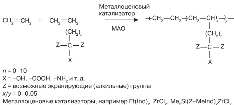
Рис. 8.2. Прямая сополимеризация олефинов с функционализированными мономерами с применением защиты функциональных групп
