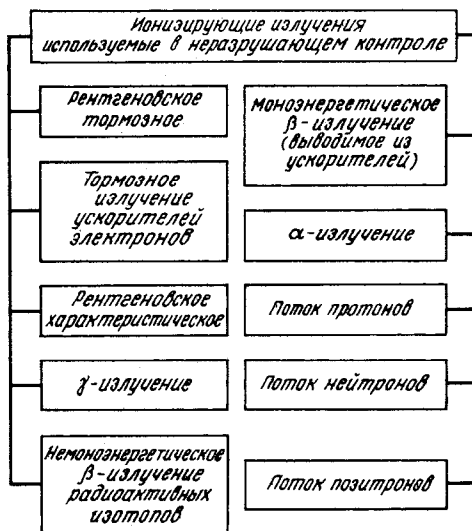
Рис. 3.46. Ионизирующие излучения, используемые в радиационной дефектоскопии и измерении толщин
