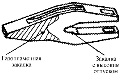
Рис. 43.4. Схема термической обработки зуба
