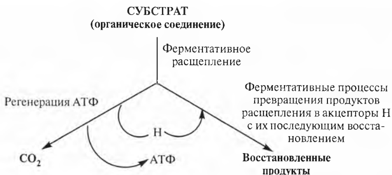
Рис. 13.4. Суммарная схема процессов брожения
