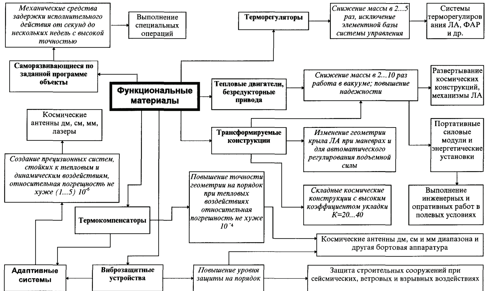
Рис. 2.11. Применение функциональных материалов из сплавов с памятью в авиакосмической технике
