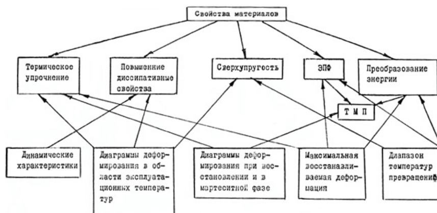
Рис. 2.9. Основные свойства сплавов с памятью и параметры их количественной оценки
