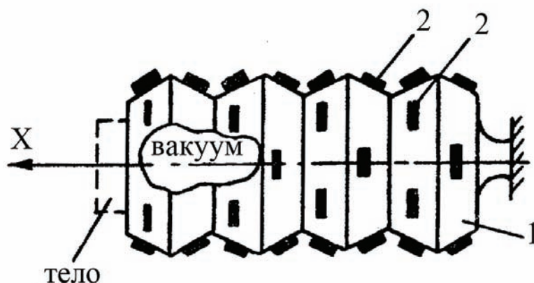
Рис. 2.23. Приводное устройство сильфонного типа.
