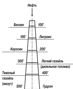
Схема разделения нефти на фракции
