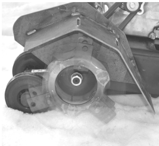
Рис. 1. Конструкция молоткового ротора (а) и испытание модели молоткового ротора (б)
