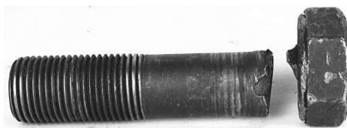
Рисунок 1 – Болт крепления крышки шатуна
