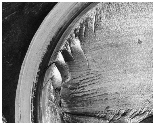
Рисунок 1 – Галтель шатунной шейки коленчатого вала
