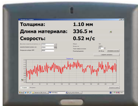
Рис. 2. Рабочая панель машиниста каландровой линии
