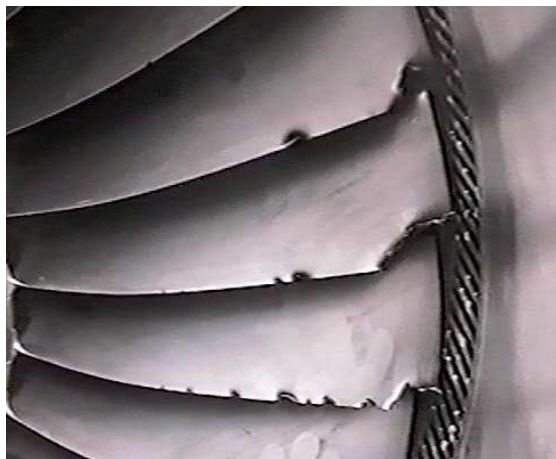
Рисунок 1 – Повреждения лопаток
