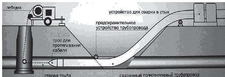
Рис.5.16. Санация старого трубопровода путем протаскивания через него пластмассового трубопровода (сваренного в плетъ)
