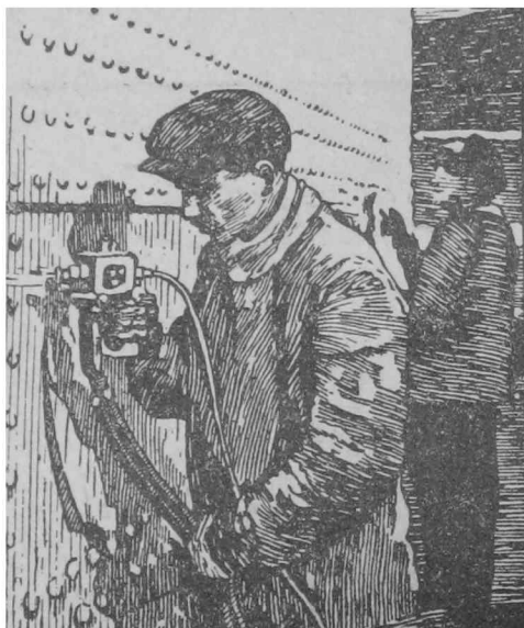
Рис. 57. Металлизация по способу Шоопа.
