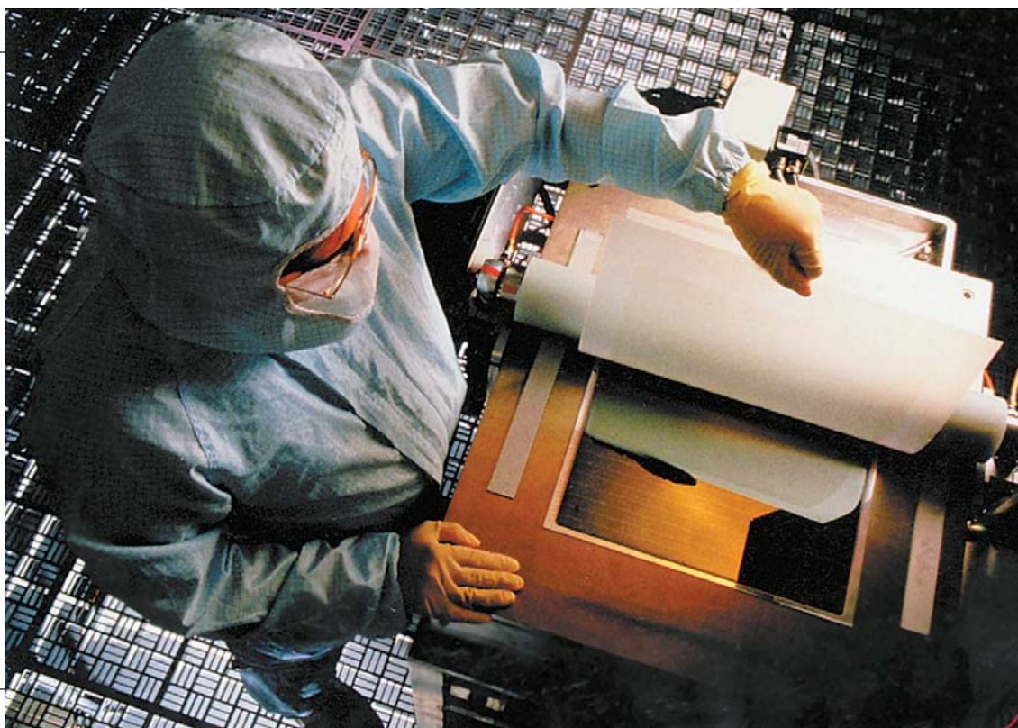
На пластине из стекла, покрытого селеном, техник готовит листы для печати цифровых рентгеновских изображений.
