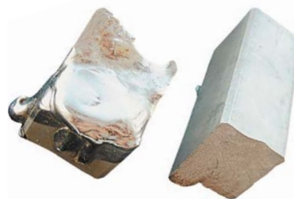
Два бруска из вольфрама, левый расплавился и потек под действием мощного электронного пучка.
