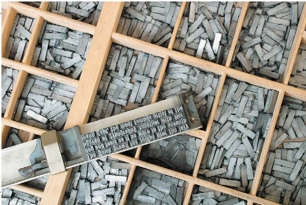
Сплавы свинца с оловом и сурьмой когда-то использовали для отливки типографского набора.
