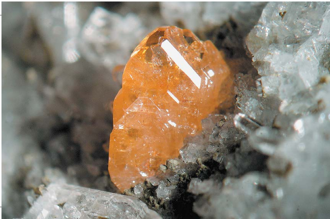
Минерал монацит — фосфат редкоземельных элементов — содержит в основном оксиды церия, лантана и неодима.
