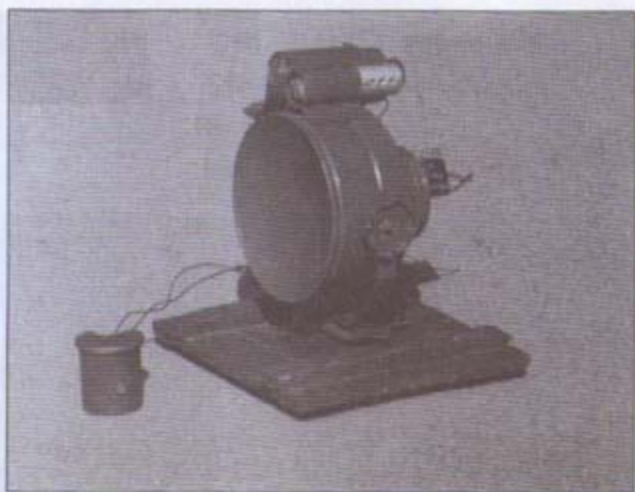
Российская противобортовая мина ТМ-83, использующая эффект ударного ядра. Из архива Ю.Г. Веремеева
