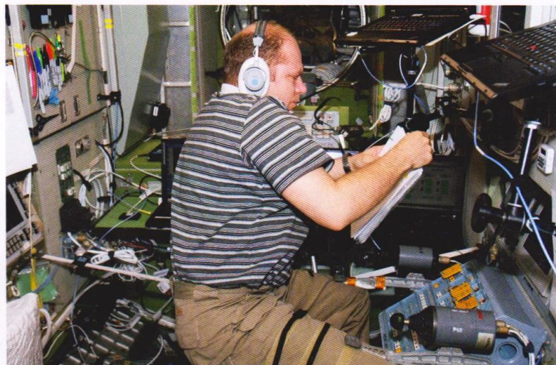
▲ Командир экспедиции МКС-38 российский космонавт Олег Котов, считывает данные ручной системы стыковки ТОРУ в служебном модуле «Звезда» во время операций сближения и стыковки с грузовым кораблем «Прогресс».
