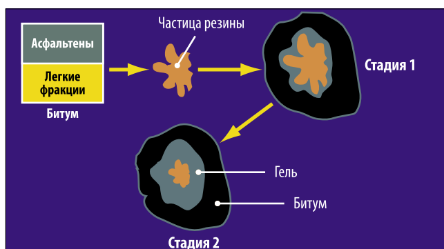
Рис. 8. Стадии реакции частиц резины и битума.
