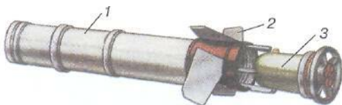
Огнемётный выстрел РПО «Рысь» (без контейнера): 1 - капсула с огне-смесью; 2 - стабилизатор с хвостовым оперением; 3 - вышибной твердо-топливный реактивный двигатель
