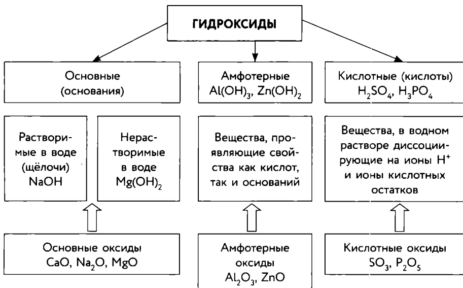
Схема 7.2. Классификация гидроксидов и сопоставление с оксидами
