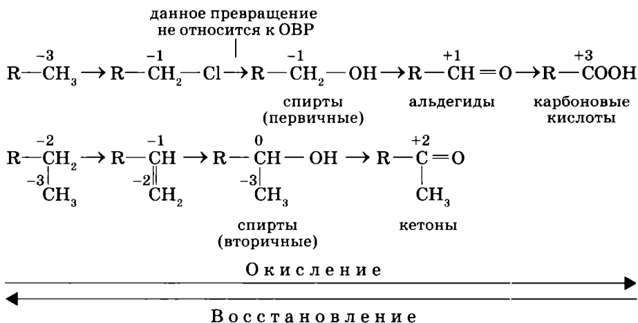
Схема 12.4. Примеры процессов окисления и восстановления в органической химии
