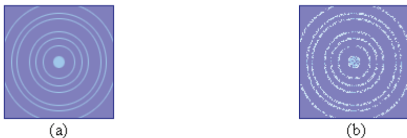
Рис. 1.2. Картина дифракции электронов на поликристаллическом образце при длительной экспозиции (a) и при короткой экспозиции (b). В случае (b) видны точки попадания отдельных электронов на фотопластинку.
