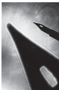
Рисунок 17. Дифракция на краю стального пера
