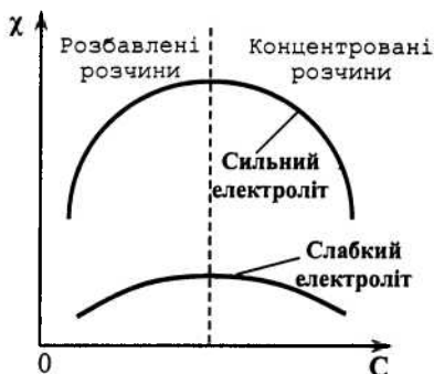
Рис. 32. Концентраційні залежності питомої електропровідності сильних та слабких електролітів
