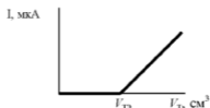
Рис. 22. Общий вид кривой амперометрического титрования, если титрант электроактивен, титруемое вещество и продукт реакции индифферентны.
