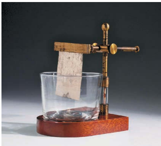
Электролитическая ванна — прибор, использовавшийся Г. Дэви для электролиза.
