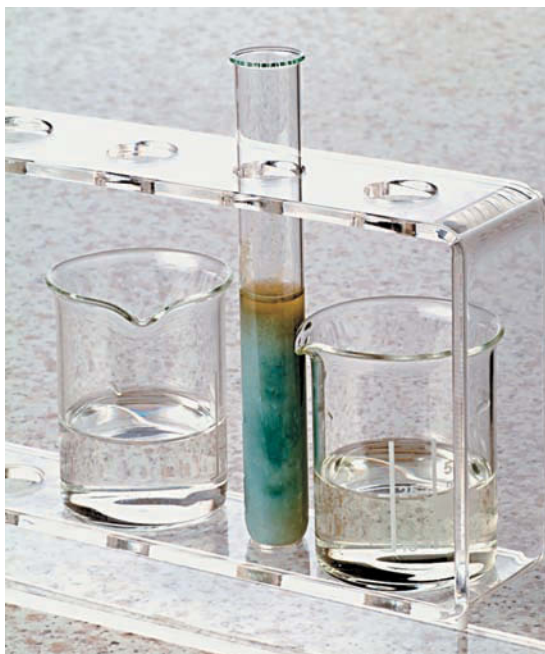
В реакции обмена \text{FeSO}_4 + 2\text{KOH} \rightarrow \text{Fe}(\text{OH})_2 + \text{K}_2\text{SO}_4 белый осадок \text{Fe}(\text{OH})_2 на воздухе меняет цвет на зелёный, а затем на бурый.
