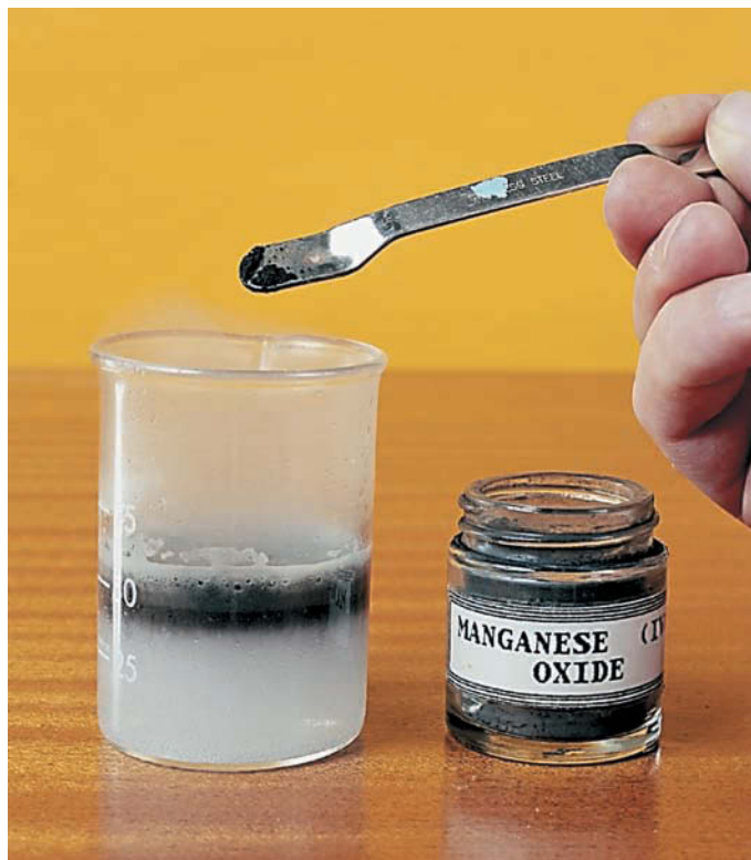
Диоксид марганца \text{MnO}_2 (тёмно-коричневый порошок) — катализатор разложения диоксида водорода \text{H}_2\text{O}_2 .
