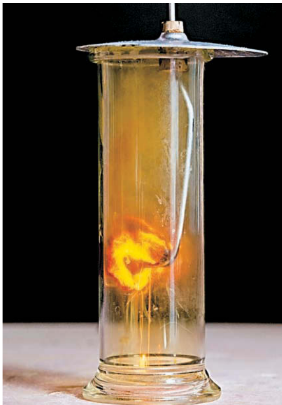
Горение железа в хлоре (экзотермическая реакция) с образованием жёлто-коричневого хлорида железа: 2\text{Fe} + 3\text{Cl}_2 = 2\text{FeCl}_3 .
