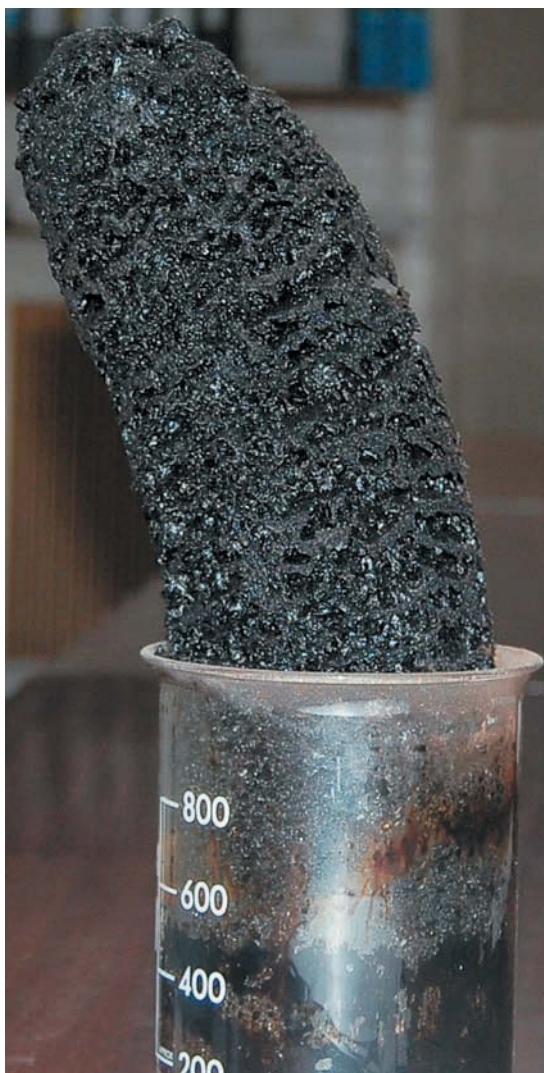
«Химическая змея» (обугливание сахарной пудры серной кислотой).
