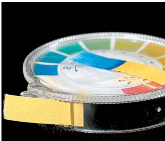
Индикаторная бумага в виде ленты для быстрого определения pH.
