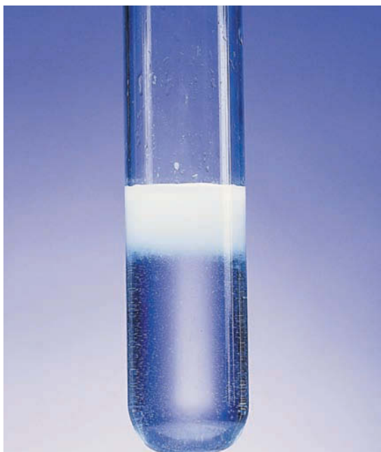
Осаждение хлорида серебра \text{AgCl} в реакции обмена: \text{AgNO}_3 + \text{HCl} \rightarrow \text{AgCl} + \text{HNO}_3 .
