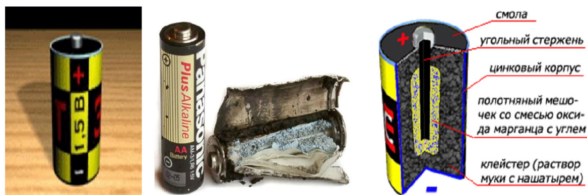
Рис. 4.4. Устройство марганец-цинкового гальванического элемента
