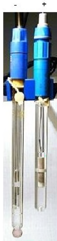
Электроды pH-метра: слева – стеклянный, определяющий [H^+] ; справа – хлорсеребряный электрод сравнения
